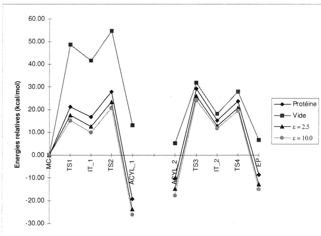
**Figure 3.22** : Diagramme des énergies relatives du chemin réactionnel dans la protéine (losange), dans le vide (carré) et dans le solvant avec  $\epsilon = 2.5$  (triangle) et  $\epsilon = 10.0$  (cercle). Calcul réalisé au niveau AM1.
