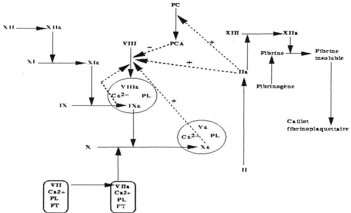
**Figure 3.3 a :** Schéma simplifié de la coagulation. La coagulation comprend plusieurs étapes de conversion d'un zymogène (facteurs XI, XII, VII, etc.) en enzyme actif (caractérisé par l'indice "a"). Certaines réactions sont accélérées en présence de cofacteurs (facteurs Va ou VIIIa), de phospholipides (PL) et d'ions de calcium ( $\text{Ca}^{2+}$ ). Les mécanismes d'activation (+) et (-) sont représentés ( $--\rightarrow$ ). FT : facteur tissulaire, PCA : protéine C activée.
