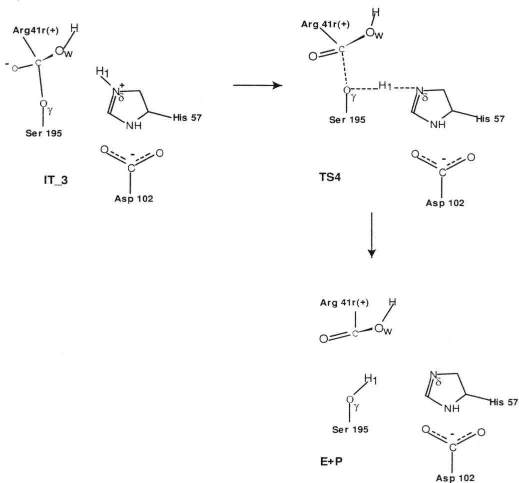
**Figure 3.16 :** Représentation schématique de la première étape de la réaction de désacylation, passage de l'acylenzyme au complexe enzyme plus produits (EP).
