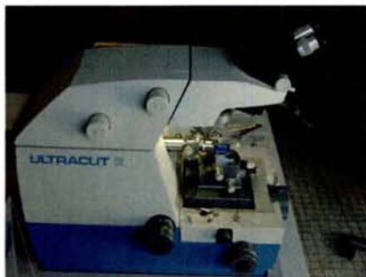
Figure II-3 : Vues à différents grossissements de l'ultramicrotome utilisé pour la préparation des lames minces.
