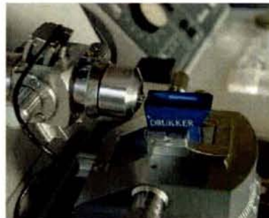
Figure II-3 : Vues à différents grossissements de l'ultramicrotome utilisé pour la préparation des lames minces.
