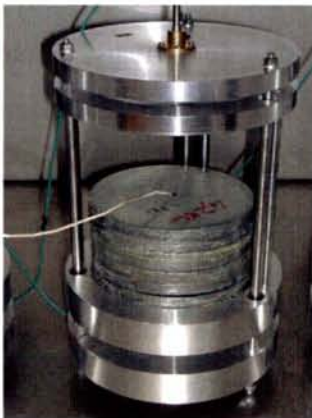
Figure II-10 : Vue d'ensemble du dispositif de fluage développé pour cette étude.
