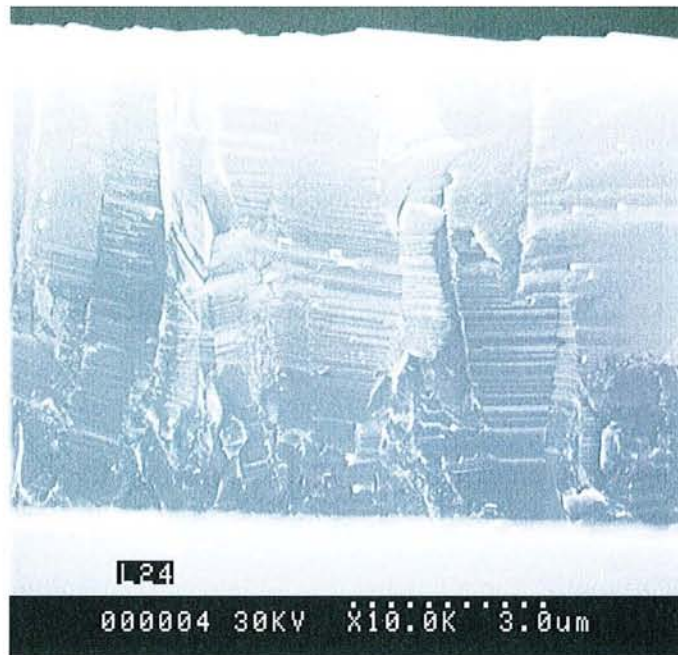
Figure I.16 : Exemple de structures colonnaires au sein d'un film élaboré au laboratoire.
