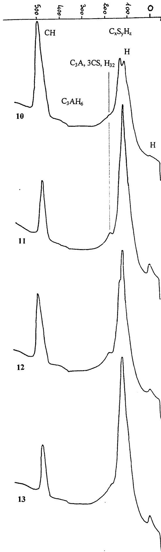
Figure 70 : Analyses enthalpiques différentielles des pâtes de ciment CEM I
