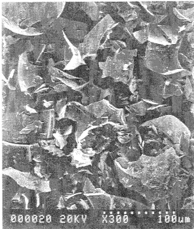
Figure 41 : Vue de Perlite (grossissement 100)
