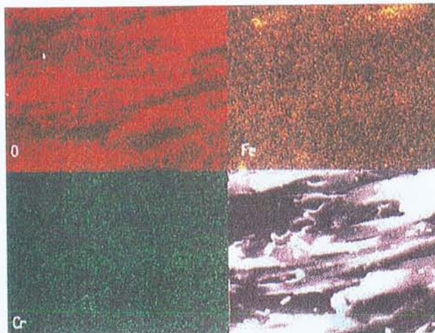
Figure III.i. : Grain LIG4 de l'échantillon WA-3 (fraction > 1 mm). Cartographie de la répartition du fer, du chrome et de l'oxygène.
