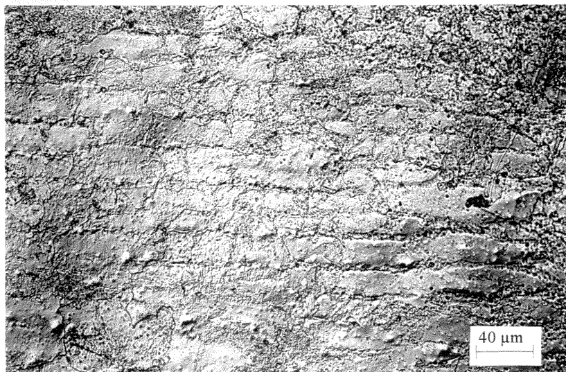
Figure III.21 : Surface des échantillons laminés (80 %) après un vieillissement de 2,5 ans à température ambiante
