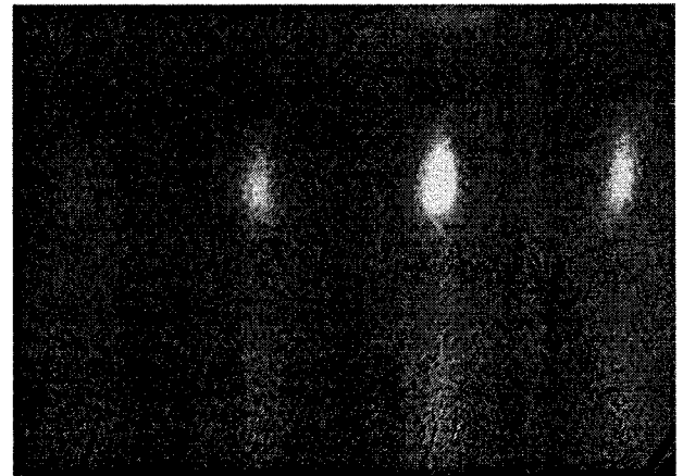
Figure E-14: Evolution des images de diffraction RHEED selon les azimuts [-110] et [010] au cours de l'évaporation de fer sur \text{MgO}(001) : (a) et (b) \text{MgO} bombardé et recuit à 800\text{ °C} , (c) épaisseur de fer de 10\text{ Å} , (d) et (e) 25\text{ Å} .
