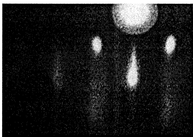
Figure E-14: Evolution des images de diffraction RHEED selon les azimuts [-110] et [010] au cours de l'évaporation de fer sur MgO(001): (a) et (b) MgO bombardé et recuit à 800 °C, (c) épaisseur de fer de 10 Å, (d) et (e) 25 Å.
