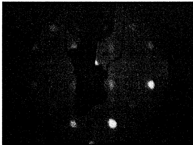
Figure E-3: Images de diffraction LEED obtenues sur un monocristal de MgO(001) bombardé et recuit à 800 °C pour différentes énergies des électrons incidents: (a) 70 eV, (b) 120 eV, (c) 170 eV.
