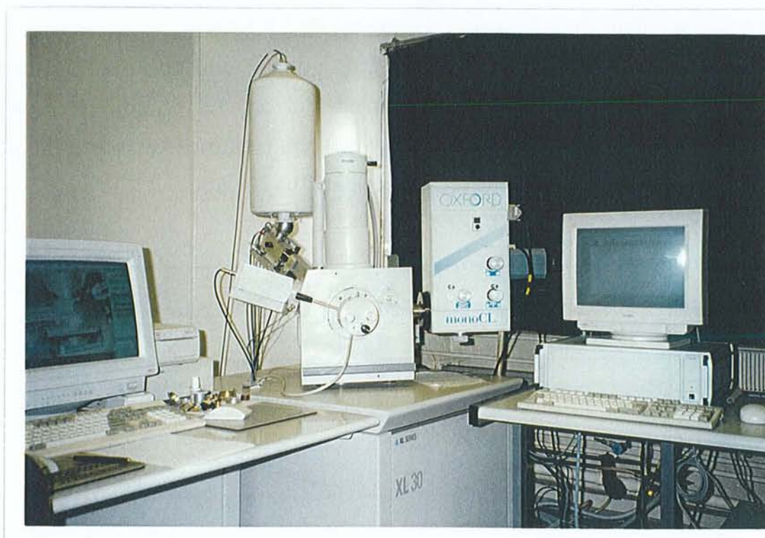
Photo III-1 : présentation du système MonoCL2 (Oxford) installé sur le M.E.B. du service commun de microanalyse de l'Université Nancy I. L'installation permet la réalisation d'images panchromatiques ou monochromatiques noir et blanc et de spectres de cathodoluminescence.
