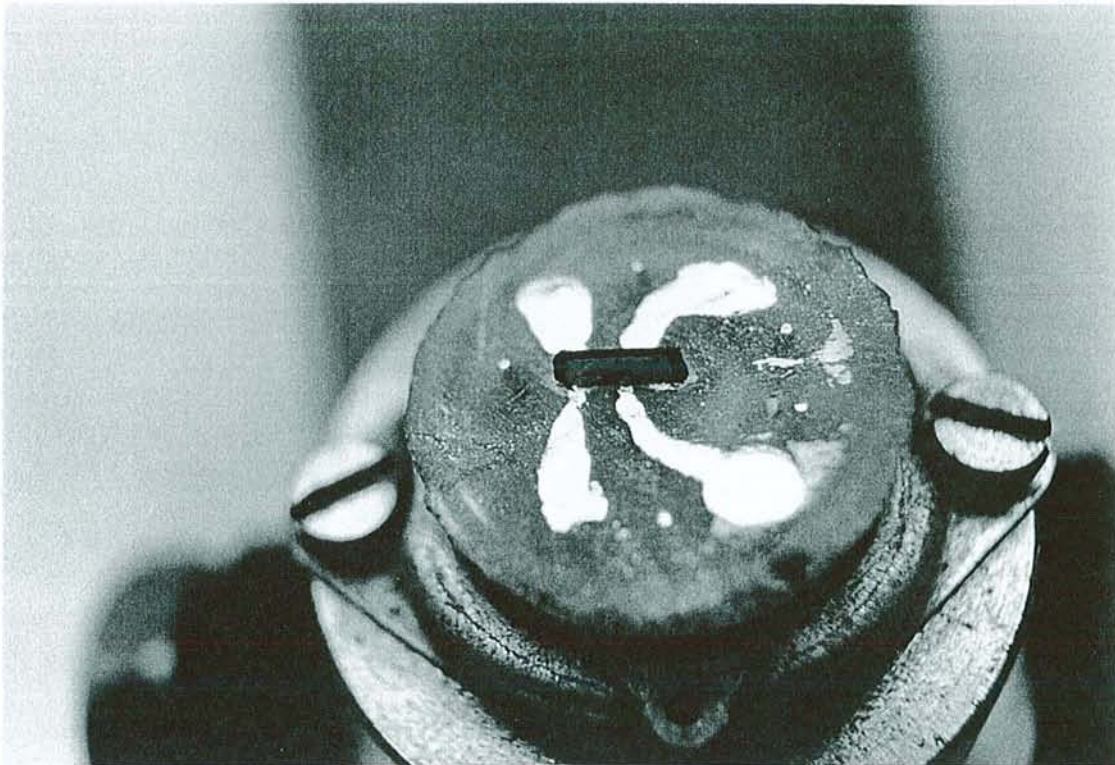
Figure 92 : Montage de l'échantillon permettant de mesurer la résistivité électrique dans la direction perpendiculaire aux plans de graphène
