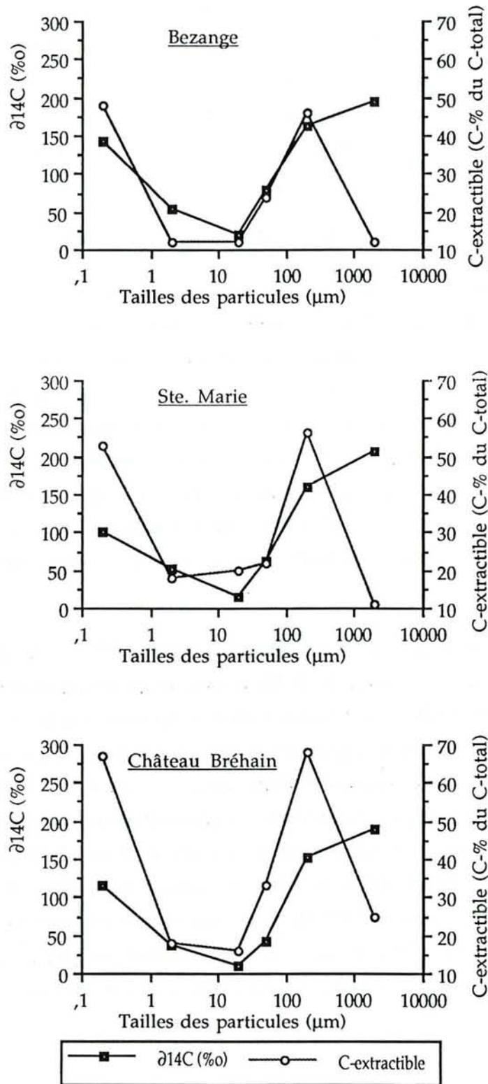
Figure III.20: Activité <sup>14</sup>C et pourcentage du carbone extractible par pyrophosphate de sodium à pH 9,7 dans les différentes fractions granulométriques des trois horizons A1.
