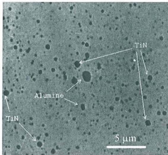
Figure 31 : Dispersion des oxydes dans l'ODS MA758 (détails)
