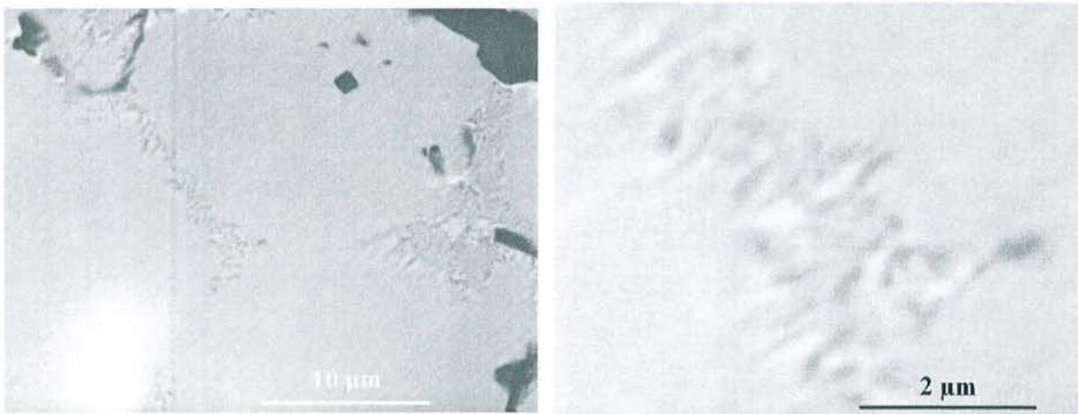
Figure 23 : Visualisation des carbures de l'alliage A19 a) Vue générale d'un joint de grain
