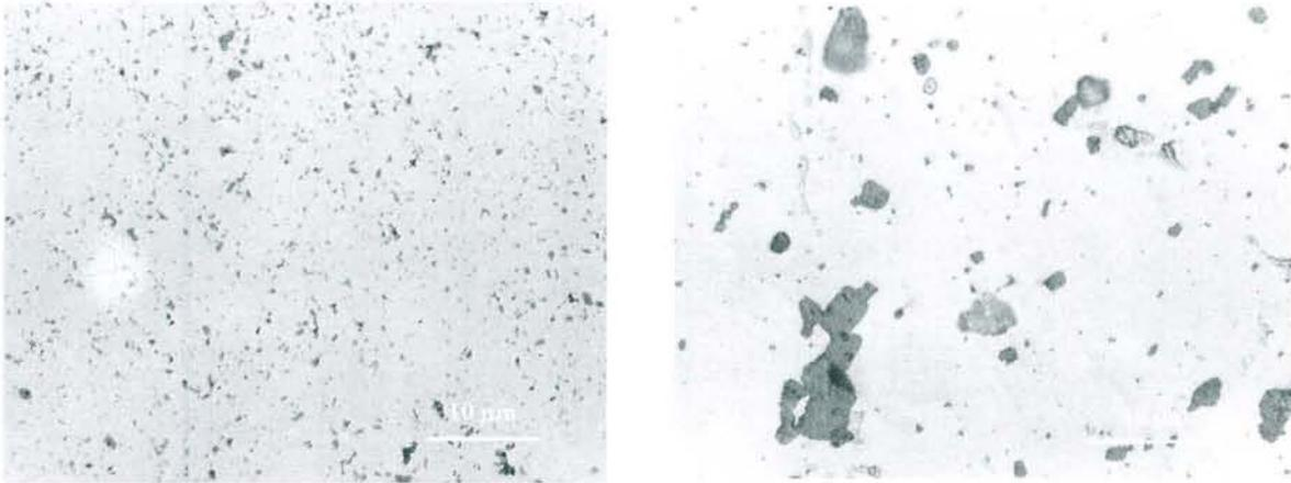
Figure 15 : Alliage A16 (5% vol de chromine) a) dispersion avant recuit b) dispersion après recuit
