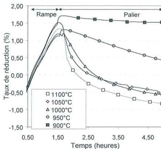
Figure 40 : Suivi par dilatométrie du frittage des poudres à différentes températures
