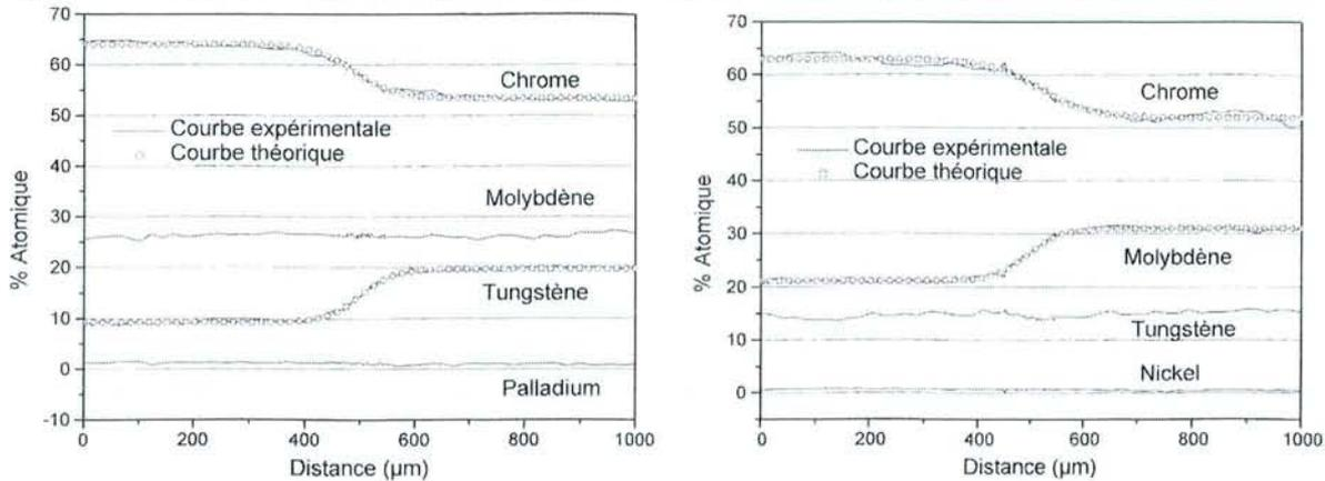
Figure 13 : couples de diffusion après 500 heures à 1300°C a) couple  $\alpha5/\alpha6$  b) couple  $\alpha7/\alpha8$
