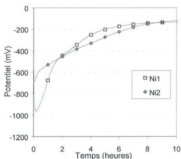
Figure 14 : Potentiel à l'abandon des alliages Ni1 et Ni2 dans le verre C3 à  $1050^{\circ}C$
