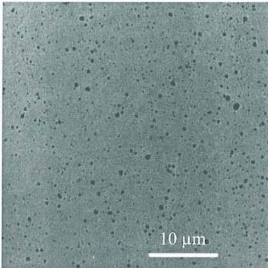
Figure 30 : Dispersion des oxydes dans l'ODS MA758
