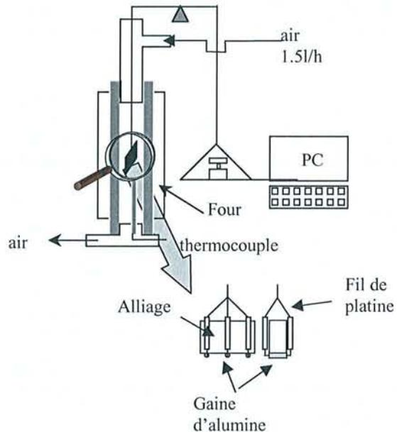
Figure 8 : Schéma de principe d'une thermobalance
