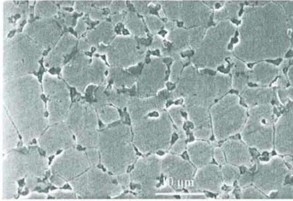
Figure 4 : Structure des alliages après frittage sous charge
