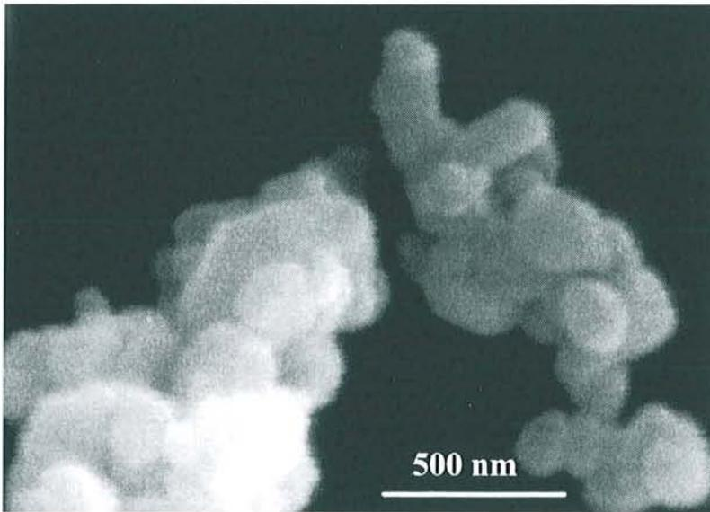
Figure 54 : oxyde de chrome nanométrique préparé par broyage de poudre micronique de  $Cr_2O_3$
