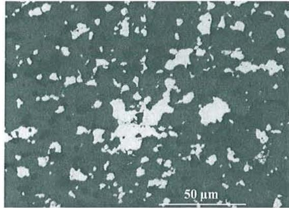
Figure 4 : Image BSE de la composition 60Cr-10Mo-30W (% atomique) frittée et recuite à 1300°C
