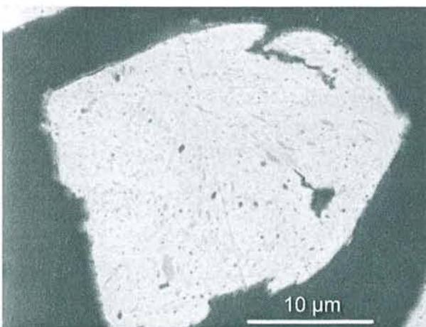
Figure 38 : visualisation d'un grain d'alliage après mécanosynthèse
