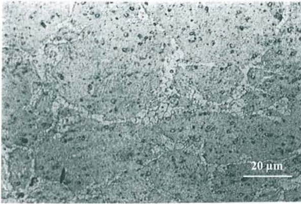
Figure 43 : Essai 4 : Visualisation de la recristallisation primaire après un compactage à 1100°C
