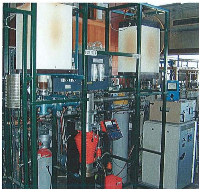
Figure 6 : Dispositif de traitement thermique des alliages
