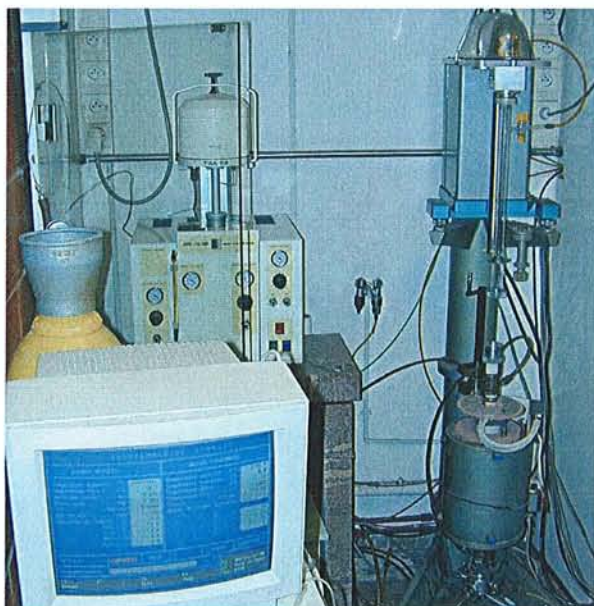
Figure 7 : Thermobalances G92 (à gauche) et B60 (à droite)
