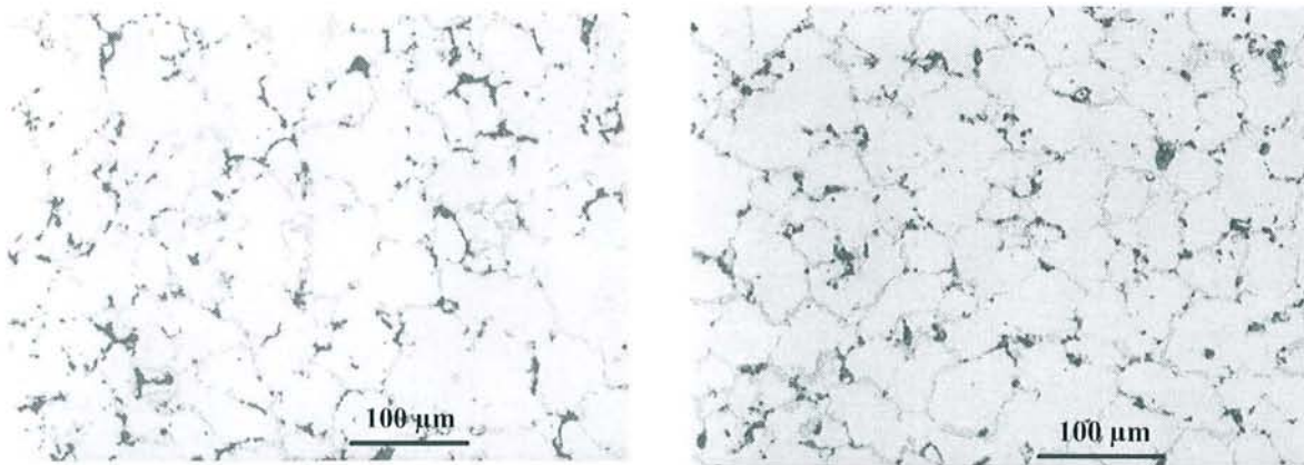
Figure 25 : Microstructure des alliages contenant Ru et Al a) Alliage A21 b) Alliage A22
