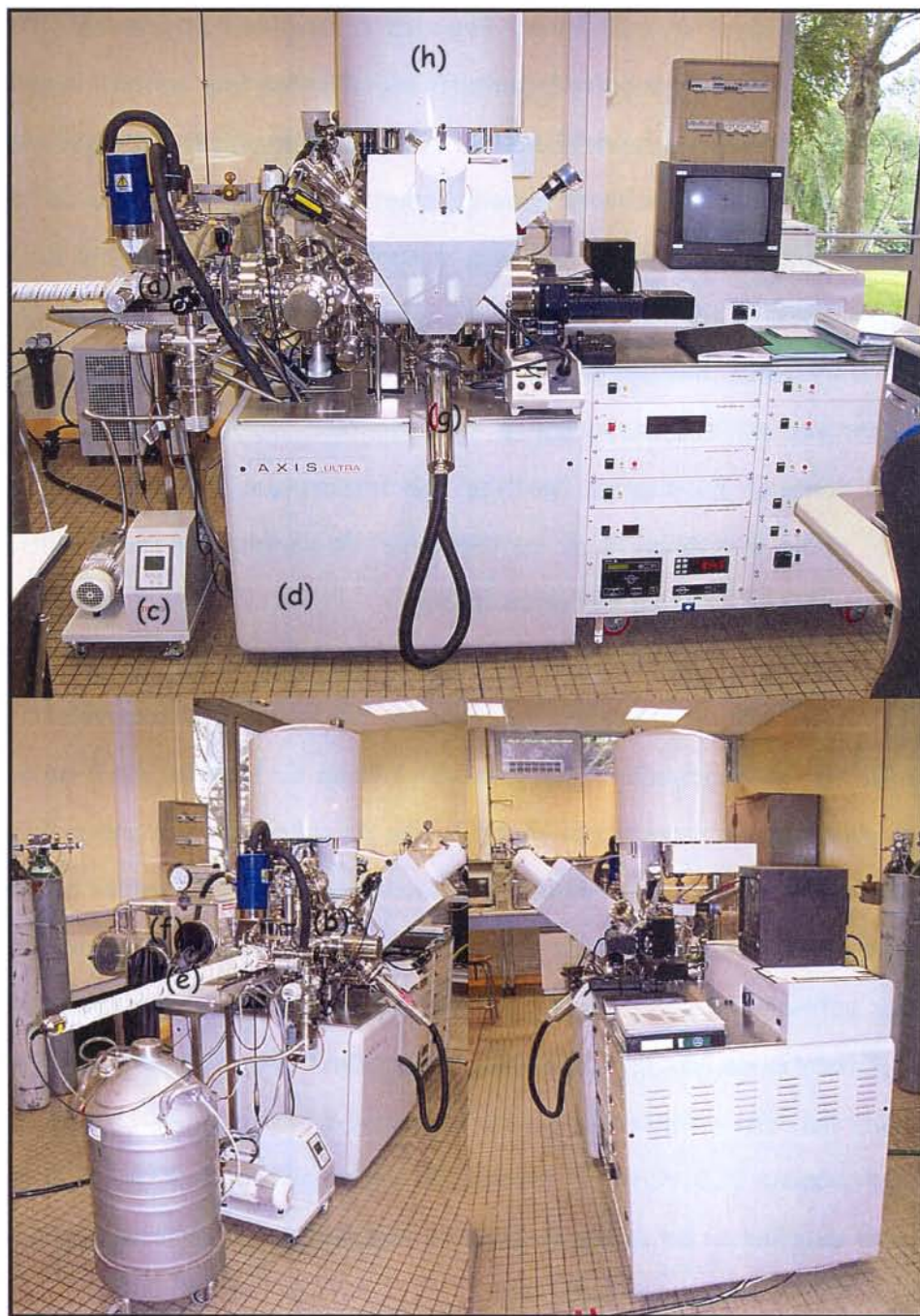
Figure III-K : Vue d'ensemble de l'appareil XPS (KRATOS Axis Ultra DLD ): (a) chambre de préparation, (b) chambre d'analyse, (c) & (d) groupes de pompage indépendants, (e) barre de transfert, (f) boîte à gants (g) source de rayon X monochromatique ( \text{Al K}\alpha ( 1486.6\text{ eV} ), (h) analyseur hémisphérique équipé d'un détecteur DLD (Delay-Line Detector, 115 canaux).
