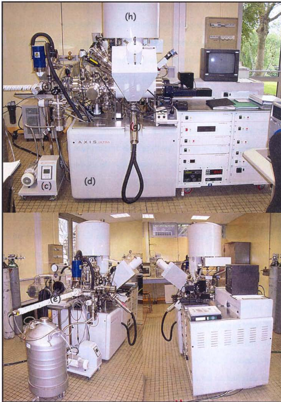
Figure III-K : Vue d'ensemble de l'appareil XPS (KRATOS Axis Ultra DLD ): (a) chambre de préparation, (b) chambre d'analyse, (c) & (d) groupes de pompage indépendants, (e) barre de transfert, (f) boîte à gants (g) source de rayon X monochromatique ( \text{Al K}\alpha (1486.6 eV), (h) analyseur hémisphérique équipé d'un détecteur DLD (Delay-Line Detector, 115 canaux).
