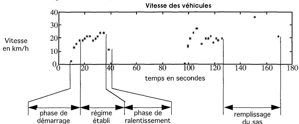
Figure 5.3.c : Vitesses des véhicules durant trois minutes
