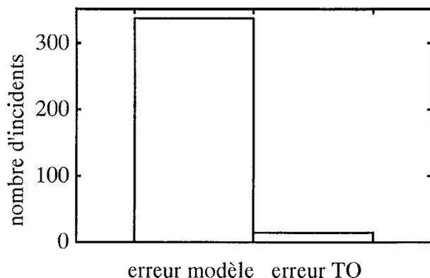
Cette courbe nous montre que le type d'erreurs le plus fréquemment rencontré est la sortie de la plage de fonctionnement définie dans l'intervalle de confiance du modèle. Elle a été appelée par l'auteur l'erreur modèle.
