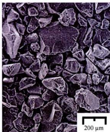
Figure 2 : Photographie par Microscopie Electronique à Balayage d'une silice Merck, Kiesegel 40Å (d'après [3]).
