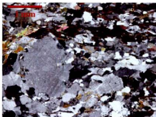
Fig.2.1A - Tipica tessitura di uno gneiss occhiadino (Kfs+Qtz+Pl+Bt+/-Ms) (Typical texture of augen gneiss)
