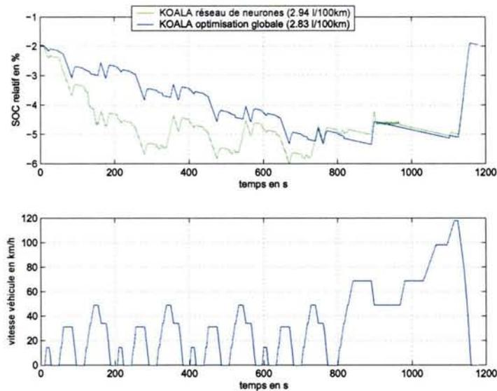
FIG. 12.13: Apprentissage sur cycles HYZEM. Utilisation sur NEDC
