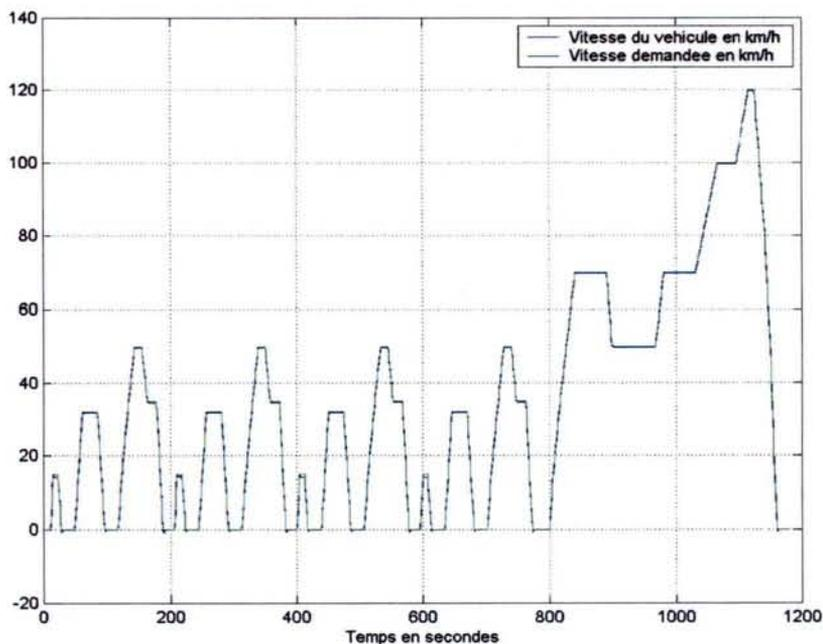
Etant donnés les excellents résultats obtenus en figure 5, nous attribuons la cause des écarts constatés figure 4 aux problèmes liés à la considération des inerties de moteurs dans Koala.
