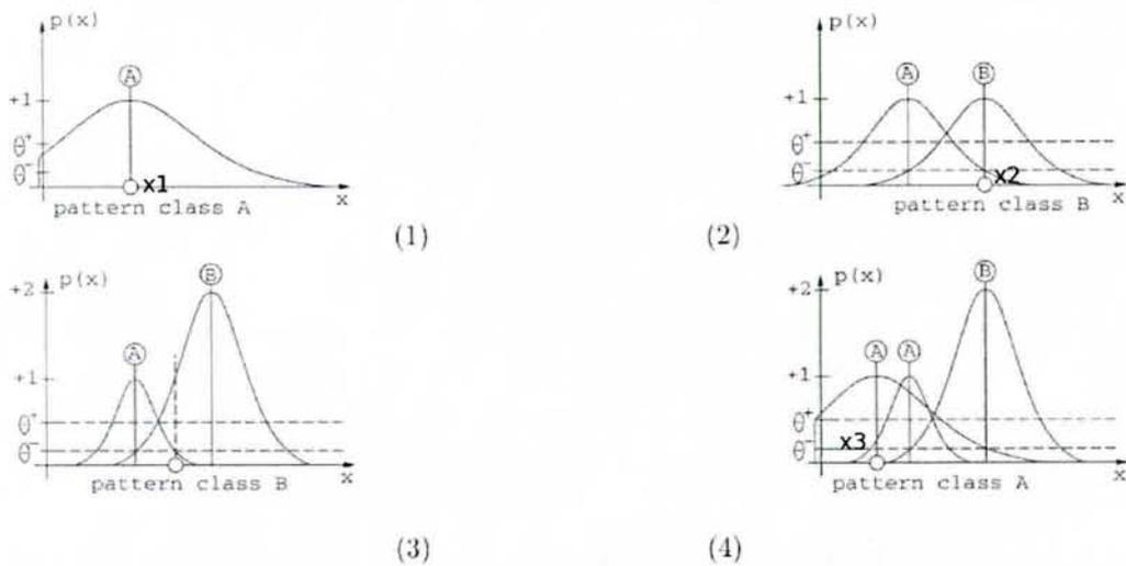
FIG. 12.3: Construction du réseau RBF-DDA sur un cas simple
