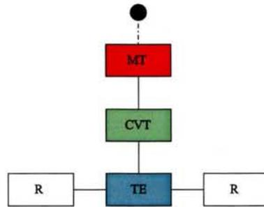
FIG. 8.4: Synoptique du véhicule thermique conventionnel idéal
