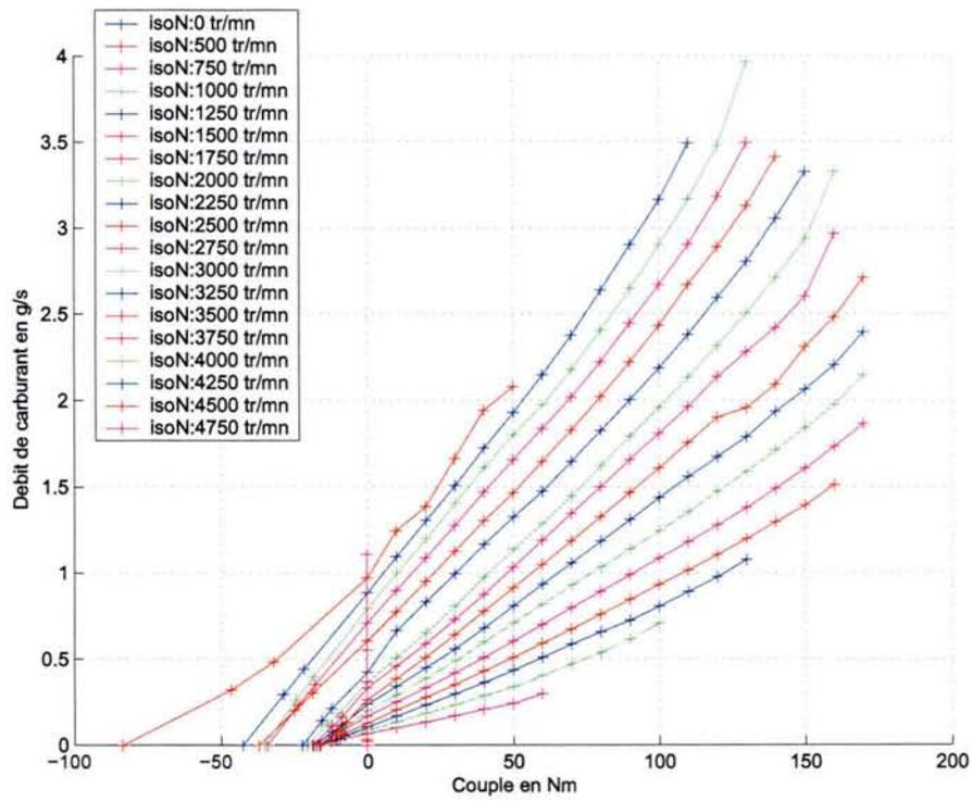
FIG. 5.4: Courbes de Willans pour le moteur K9K
