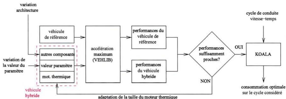
FIG. 10.1: Procédure de dimensionnement du véhicule hybride
