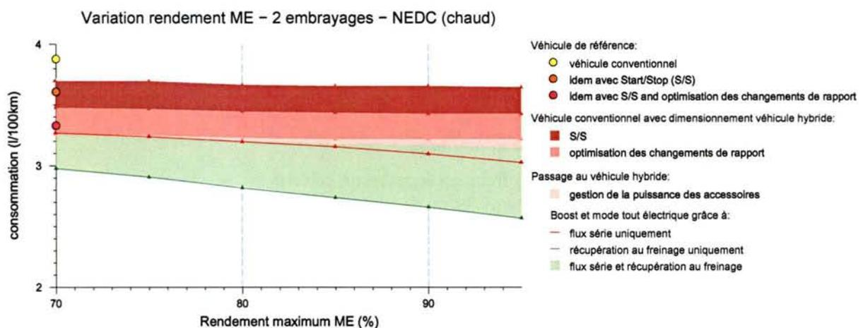
FIG. 10.3: Variation de la consommation en fonction du rendement maximum du moteur électrique
