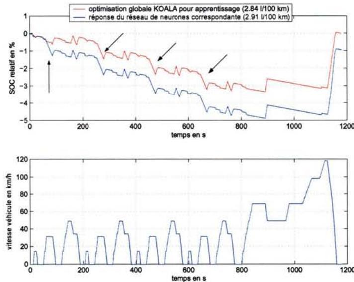
FIG. 12.7: Apprentissage sur NEDC à un seul état de charge, réponse du réseau correspondante
