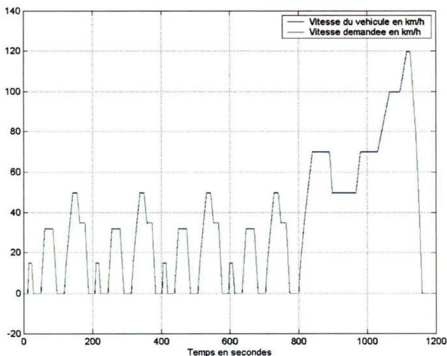
**Figure 9 – Cycle Hysem Urbain avec régulation du couple moteur thermique et du frein mécanique**
