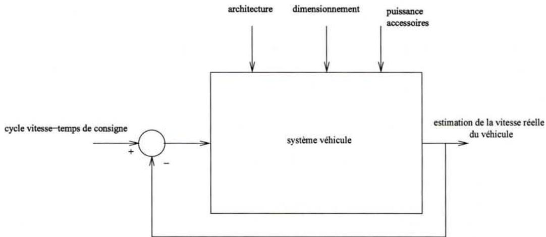
FIG. 5.1: Système véhicule conventionnel en modélisation forward
