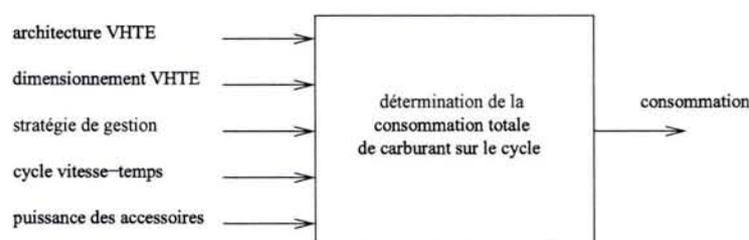
FIG. 4.1: Détermination de la consommation sur un cycle
