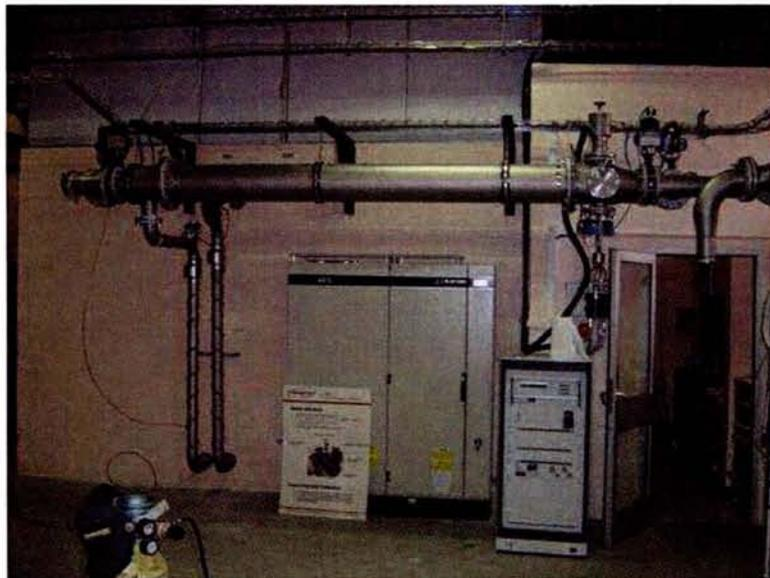
FIG. 13.5: Système d'analyse des polluants du LTE
