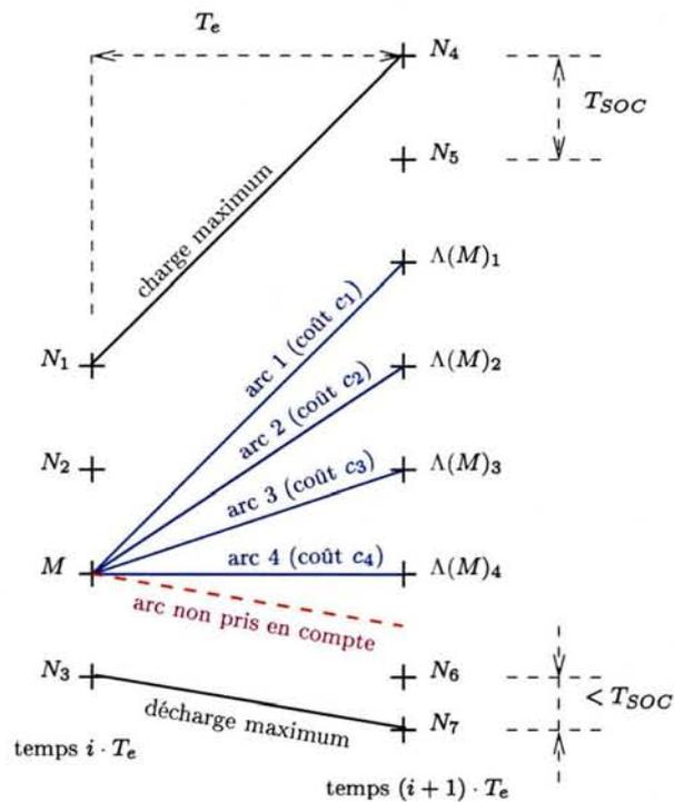
FIG. 8.2: Éventail de possibilités de courant batterie  $I_B$  à chaque instant (schéma de principe)
