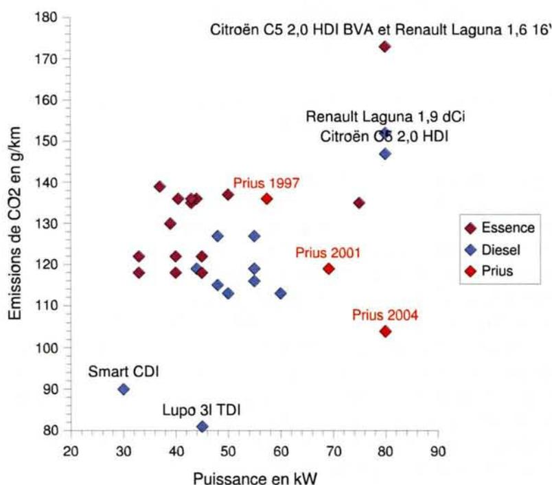
FIG. 2: Émissions de CO<sub>2</sub> du cycle normalisé européen en fonction de la puissance pour divers véhicules vendus en France
