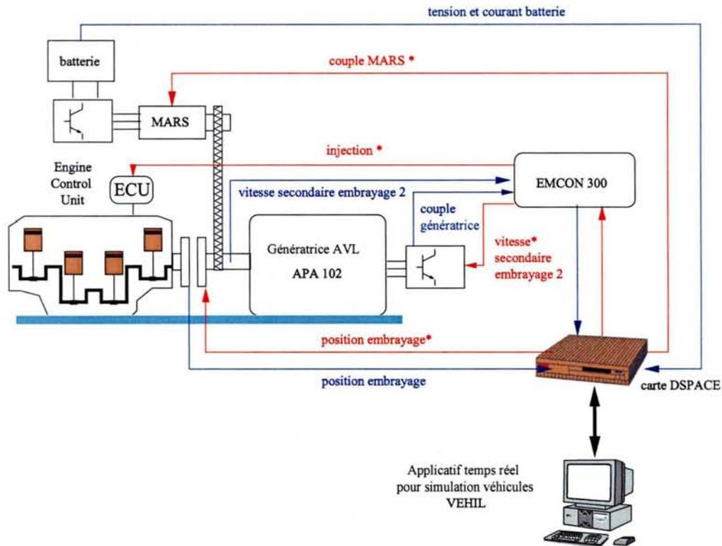
FIG. 13.4: Synoptique du banc moteur dynamique du LTE
