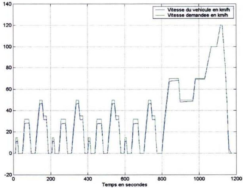
Comme expliqué au paragraphe précédent, il se peut que la différence de suivi de cycle soit due aux inerties des moteurs thermique et électrique. Pour vérifier cette hypothèse, nous décidons donc d'annuler les inerties dans VEHLIB aussi bien pour la génération de données pour Koala, que pour la validation des résultats avec le modèle simplifié de VEHLIB. Les résultats obtenus sont visibles en figure 5.
