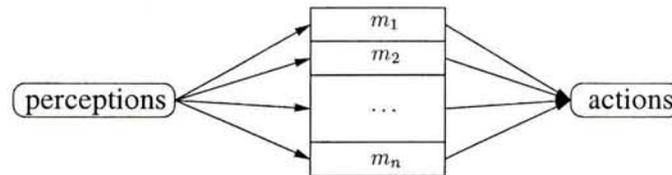
FIG. 1.6 – Principe d'une architecture horizontale.
