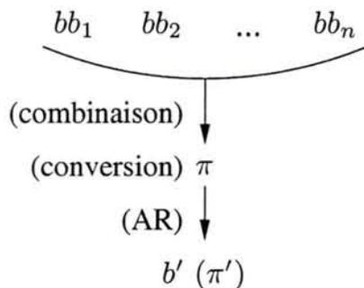
L'algorithme proposé combine les comportements de base  $bb_1, bb_2 \dots bb_n$  (apprend les paramètres de pondération), obtient une politique  $\pi$ , et l'utilise comme racine d'une nouvelle phase d'apprentissage conduisant à un nouveau comportement  $b'$  (de politique localement optimale  $\pi'$ ).
