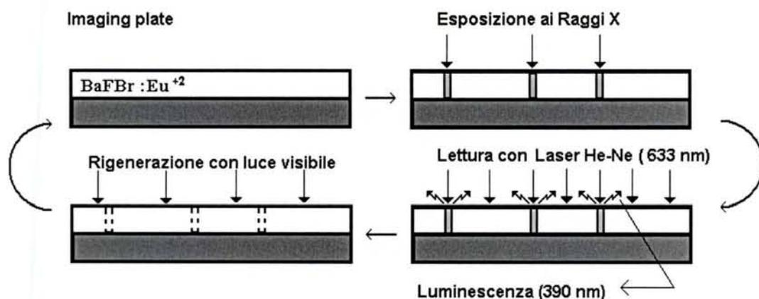
Figura 5. Rappresentazione schematica del rivelatore *imaging plate*.
