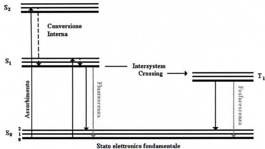
**Figura 20.** Diagramma delle transizioni elettroniche di Jabłoński. Assorbimento ed emissione di fluorescenza (S<sub>1</sub>-S<sub>0</sub>) e fosforescenza (T<sub>1</sub>-S<sub>0</sub>).
