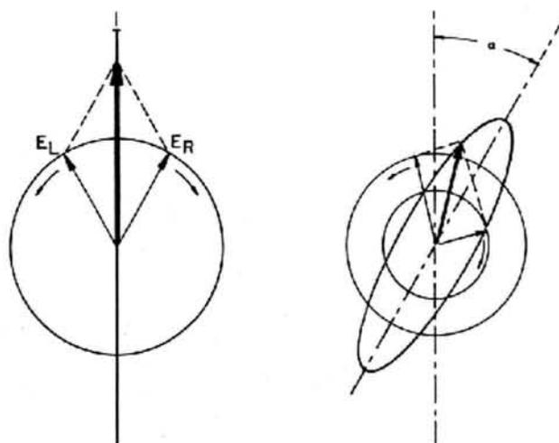
**Figura 34.** Sovrapposizione delle radiazioni circolarmente polarizzate a destra e sinistra di uguale ampiezza e fase. Il differente assorbimento delle due componenti della radiazione da parte di mezzo chirale genera l'ellitticità descritta come  $\theta$ .
