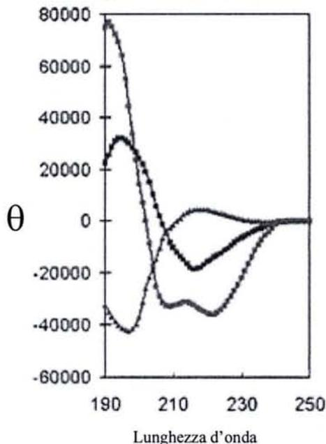
**Figura 36.** Rappresentazione di tipici spettri di struttura  $\alpha$ -elica (rosso),  $\beta$ -sheet (blu), e *random coil* (viola) riportati come ellitticità molare ( $\theta$ ) in funzione della lunghezza d'onda (nm).
