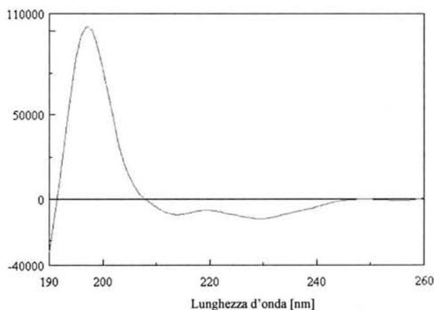
**Figura 34.** Spettro di dicroismo circolare riportato come ellitticità molare per residuo ( $\theta$ ) in funzione di  $\lambda$  per il peptide SDF-1[RFF<sub>4</sub>] in tampone fosfato 10 mM a pH 7.2, in presenza di trifluoroetanolo.
