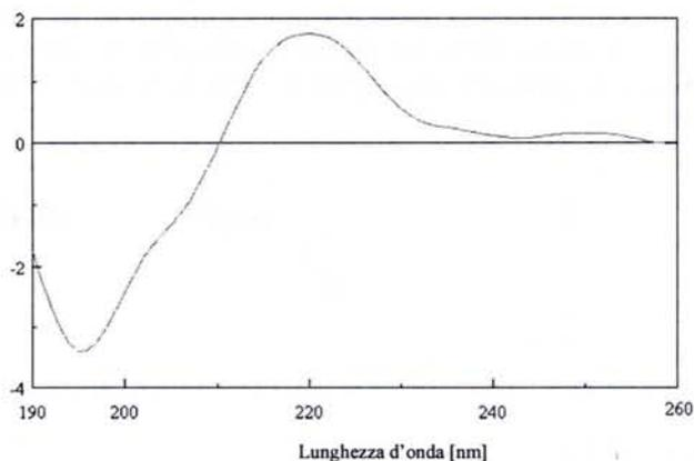
**Figura 32.** Spettro CD riportato come ellitticità in funzione di  $\lambda$  per il peptide SDF-1[HG<sub>3</sub>H] in tampone fosfato 10 mM a pH 7.2.
