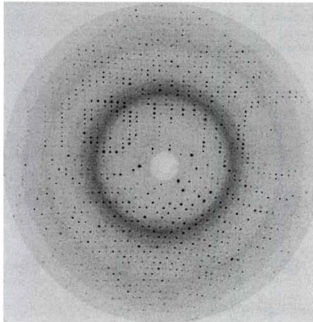
Figura 11. Tipica figura di diffrazione dei raggi X raccolta da Area detector.
