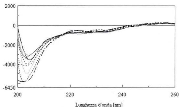
**Figura 28.** Sovrapposizione degli spettri di dicroismo circolare riportato come ellitticità molare per residuo ( $\theta$ ) in funzione di  $\lambda$  per il peptide SDF-1[1-17] in tampone fosfato 10 mM a pH7.3, titolato con dodecilsolfocolina. È evidente uno spostamento del minimo da una lunghezza d'onda di 200 nm (nero) a circa 205 nm (rosa).
