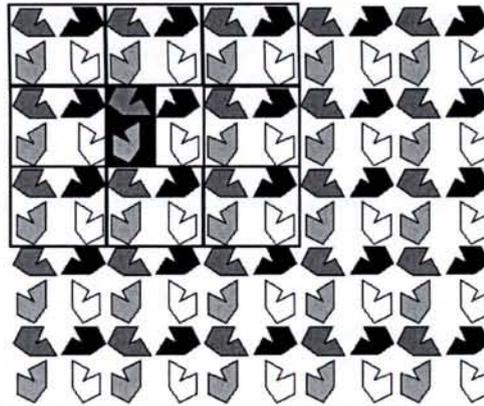
**Figura 6.** Rappresentazione schematica di un cristallo generato per traslazione della cella elementare.
