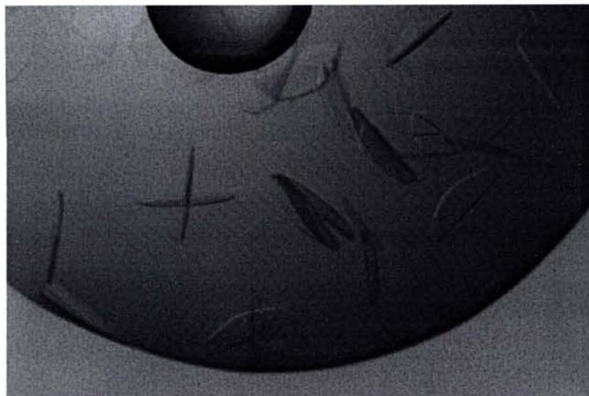
**Foto 3.** Cristalli del mutante C51S della Prx BCP cloroplastica da pioppo ottenuti a 293 K in una soluzione di 0.1 M sodio citrato pH 5.6, potassio e sodio tartrato 0.2 M e  $(\text{NH}_4)_2\text{SO}_4$  2.0 M.
