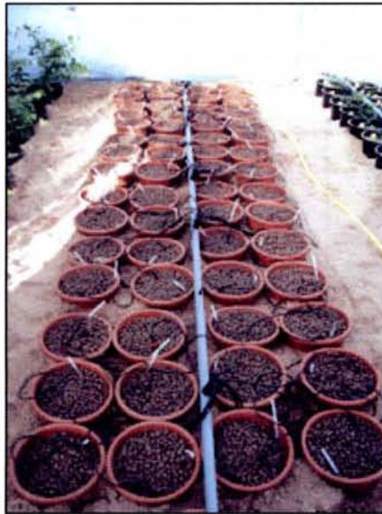
Figure 4.5. Pots utilisés pour mesurer la respiration rhizosphérique. Le substrat est non respirant (i.e. sable grossier + couche de billes d'argile expansé).
