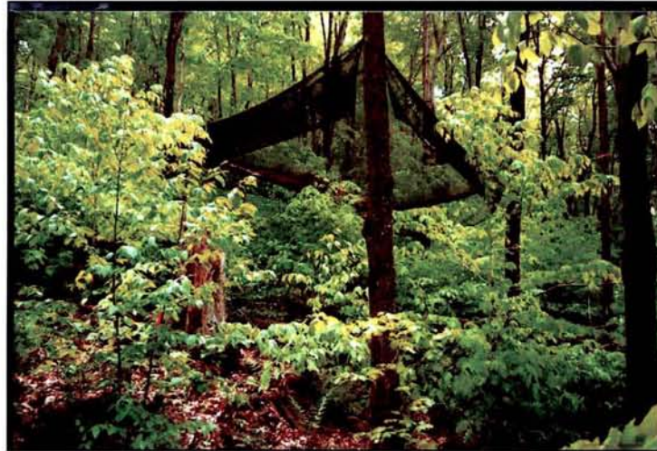
Figure 4.2. Exemple d'ombrière installée en sous couvert à la station forestière de Duchesnay afin de réduire de 50% la disponibilité en lumière. Des semis étaient suivis à côté et sous les ombrières (étiquette rouge).
