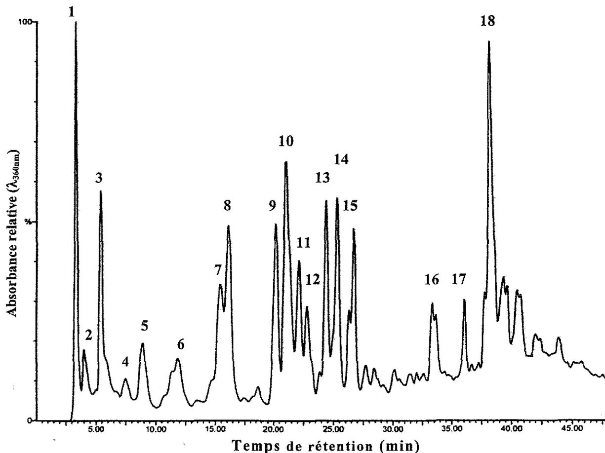
**Figure 31 :** Profil chromatographique des composés carbonylés (dérivés DNPH) identifiés par LC-MS dans une fraction polaire ( $R_f$ : 0 - 0,1) de linoléate de méthyle oxydé (détection UV  $\lambda_{360}$  nm).
