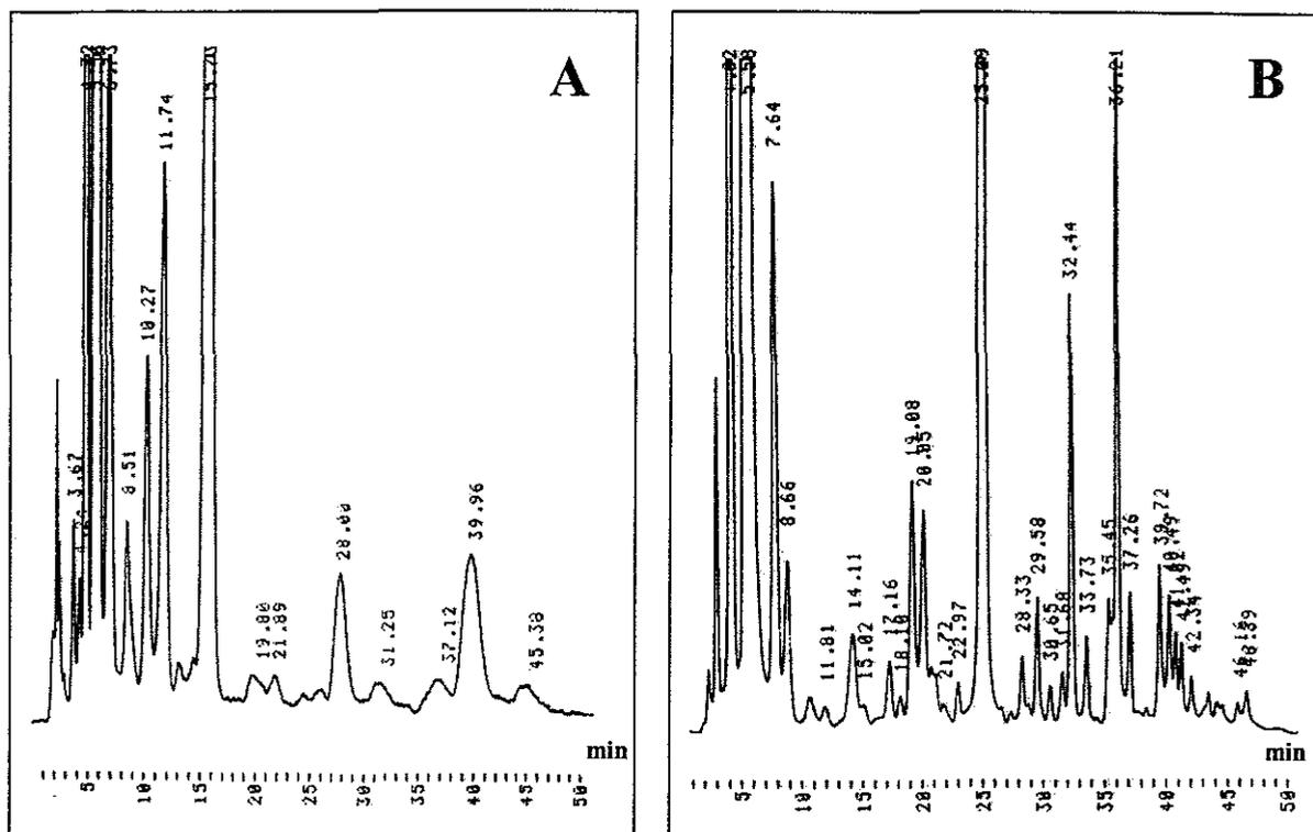
**Figure 24 : Comparaison des profils CLHP en mode isocratique (A) et en mode gradient (B).**
