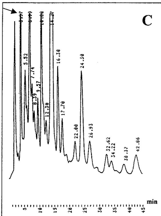
**Figure 20 : Chromatogrammes types des produits d'oxydation totaux (dérivés DNPH) du linoléate de méthyle (A) et linoléate de méthyle (B et C).**
