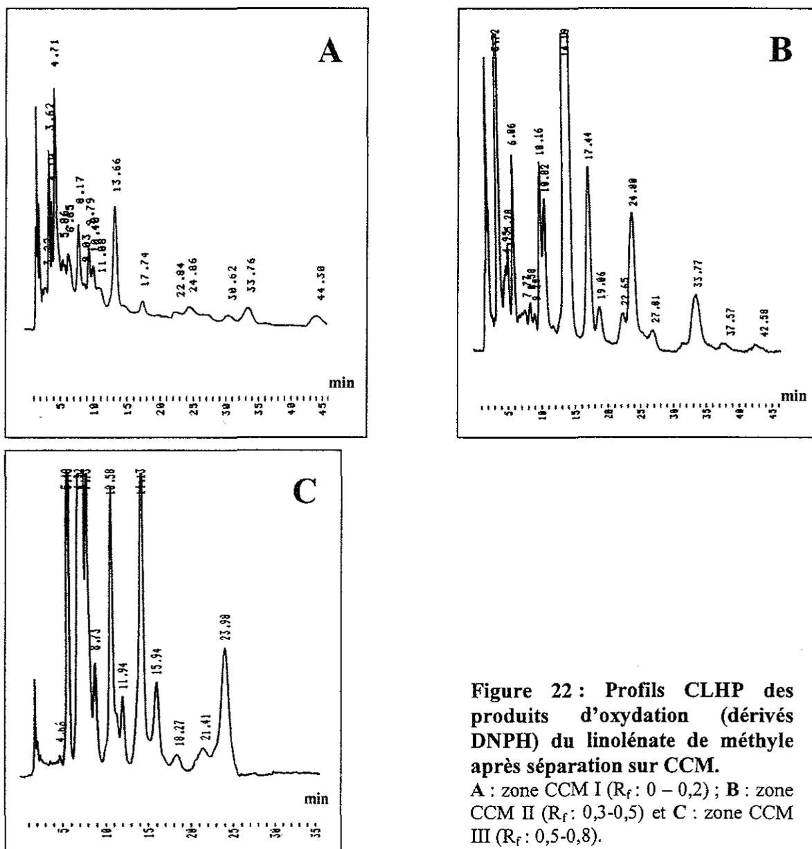
Figure 22 : Profils CLHP des produits d'oxydation (dérivés DNPH) du linoléate de méthyle après séparation sur CCM. A : zone CCM I ( $R_f$ : 0 – 0,2) ; B : zone CCM II ( $R_f$ : 0,3-0,5) et C : zone CCM III ( $R_f$ : 0,5-0,8).
