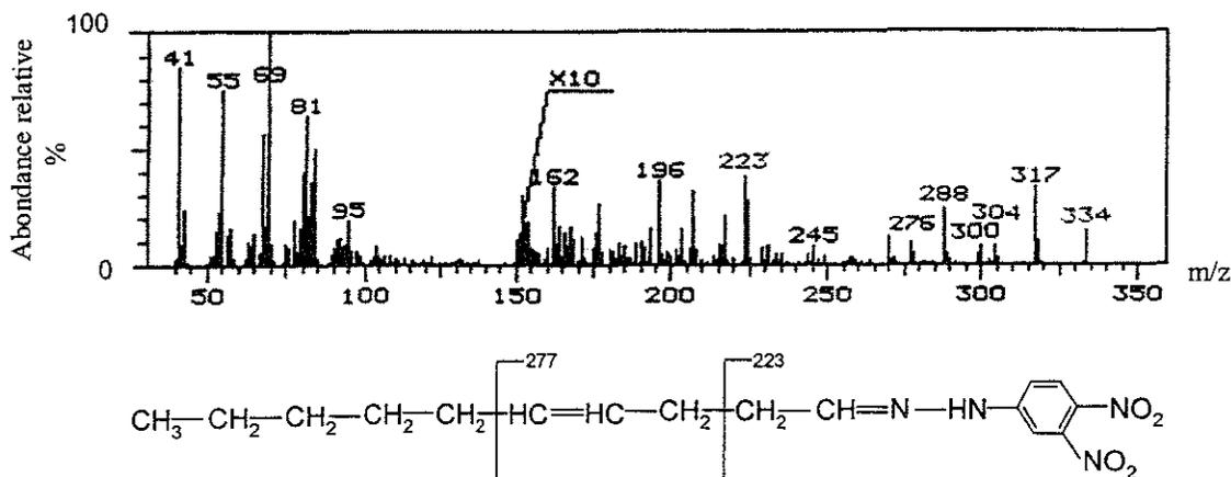
Figure 25 : Spectre EI du 4-décéнал-DNPH (M=334).
