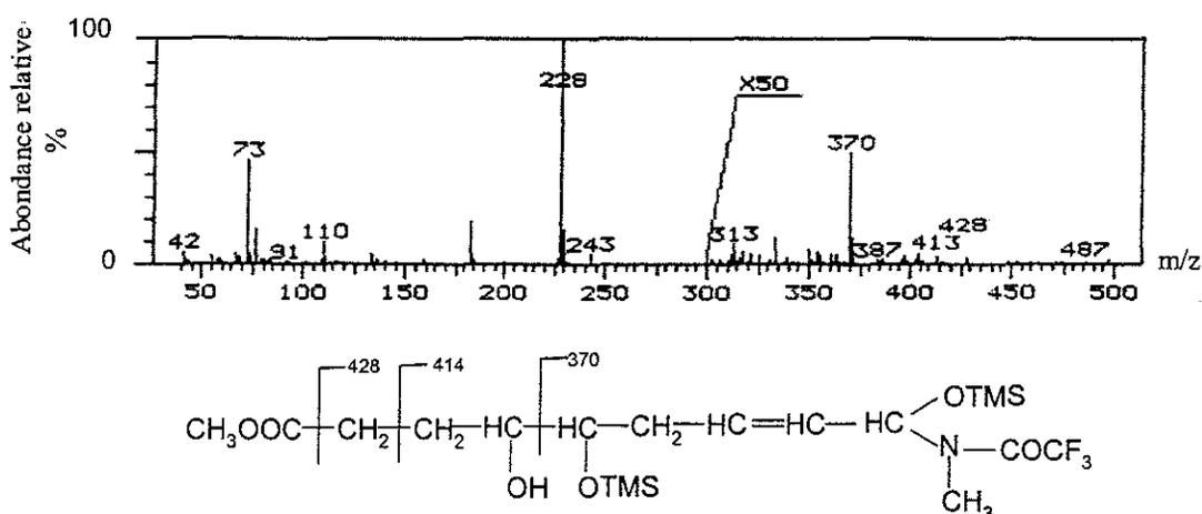
Figure 30 : Spectre EI du 4,5-dihydroxy-9-oxo-nonanoate de méthyle (silylé) (M=487).
