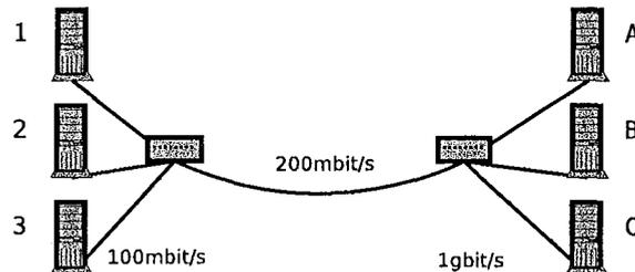
FIG. 1.1 – Exemple de configuration réseau
