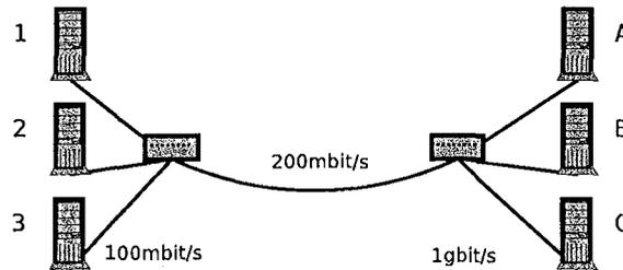
FIG. 5.1 – Configuration réseau hétérogène de grappes homogènes
