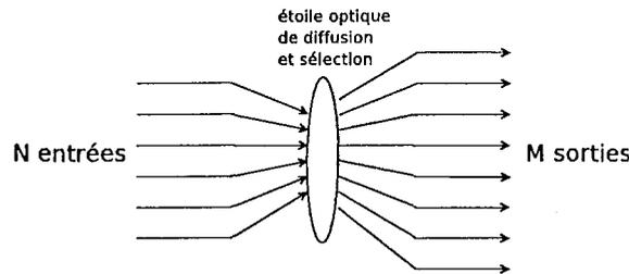
FIG. 3.22 – Étoile optique de diffusion et sélection
