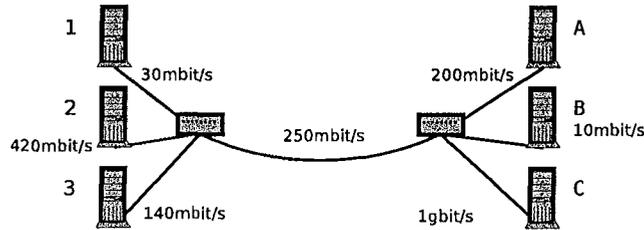
FIG. 5.3 – Configuration réseau de grappes hétérogènes
