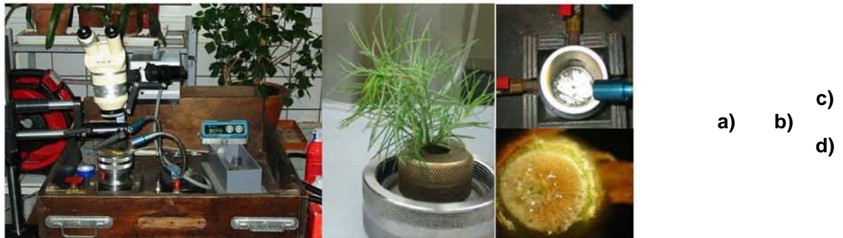
Figure C-14 : Mesure du potentiel de base sur une plantule en utilisant la chambre de Schölander. De gauche à droite, dispositif avec chambre et loupe binoculaire (a), couvercle de la chambre et maintien de la plantule au niveau du collet (b), vue de l'intérieur de la chambre avec les arrivées et sortie d'azote comprimé (c), vue de la tige avec début d'exsudation de la sève sous l'effet de la pression (d).
