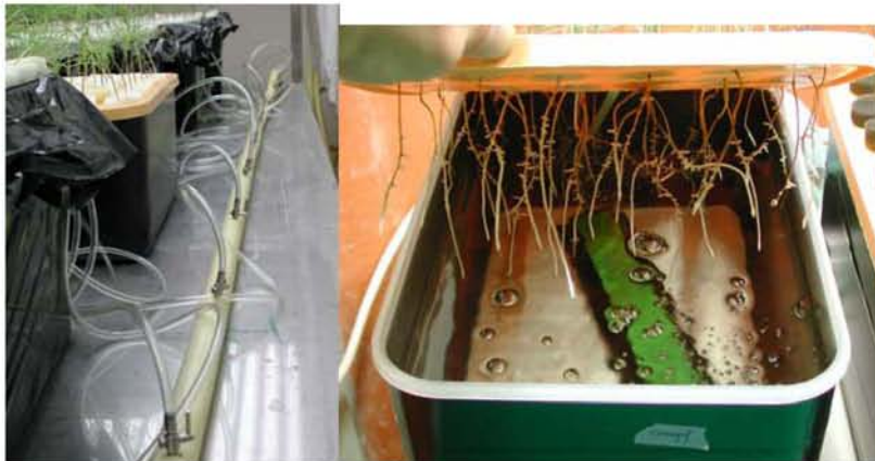
Figure C-5 : Système d'oxygénation de la solution nutritive par injection d'air à travers des diffuseurs pour aquarium.
