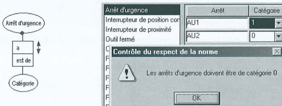
Figure 80 : Concept d'arrêt d'urgence et de catégorie : le modèle partiel NIAM/ORM, la partie de maquette correspondante.
