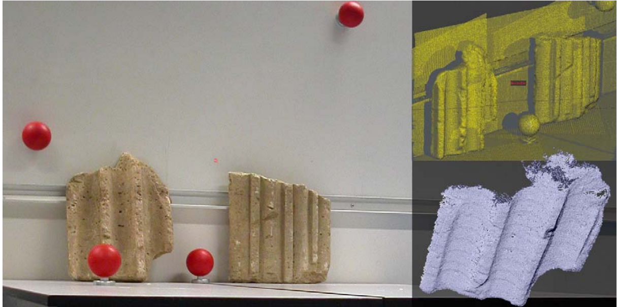
Figure -4-4 : Le relevé au scanner laser SOISIC des fragments de colonne. A gauche la scène avec les sphères repère et à droite un nuage de points obtenu et le détail d'un fragment cannelé.
