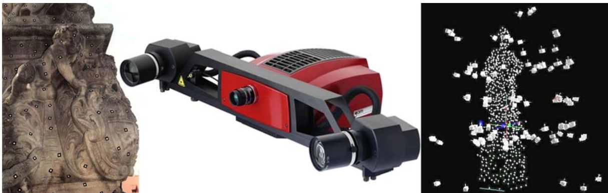
Figure 2-37 : Capteur à projection de lumière structurée - le système ATOS III de GOM GmbH. De gauche à droite : un détail de statue avec points de référence, le capteur ATOS III et le nuage de points obtenu pour l'ensemble de la statue. [GOM05]
