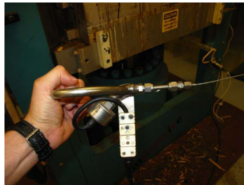
figure 75: Technologie des capteurs PressMan (pression de vapeur et température)
