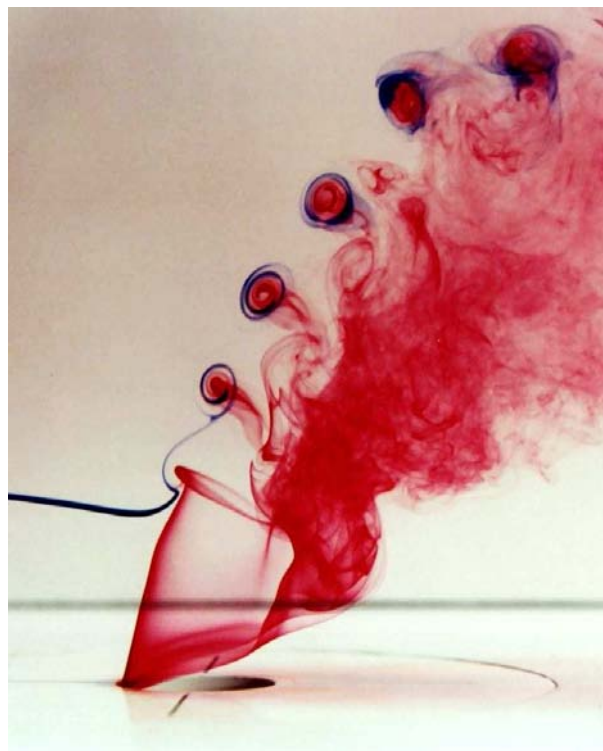
FIG. 1.7 – Instabilité de Kelvin-Helmholtz entre deux couches fluides présentant un cisaillement de vitesse. Image réalisée par Kelso et al. [35]
