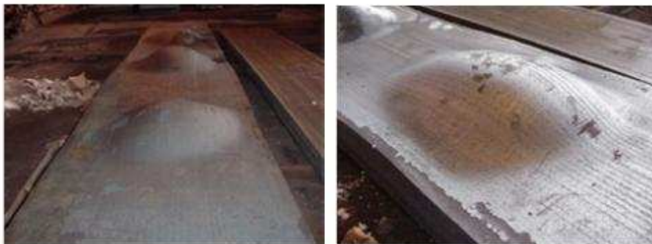
Figure 7 : Soufflures dans les tôles d'aciers provoquées par la présence de gaz lors de la solidification.
