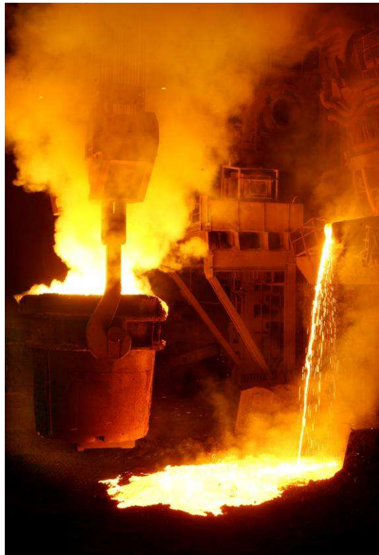
Figure 5 : La fonte est purifiée de son carbone par injection d'oxygène dans le convertisseur. Le métal liquide est ensuite versé dans la poche puis transporté dans le stand où il sera désoxydé par précipitation d'oxydes et où la composition chimique de l'acier sera fixée.
