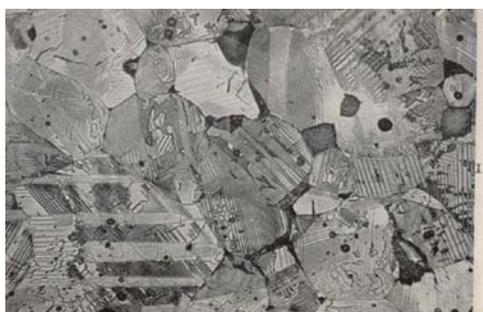
**FIG. 1.19 :** Microstructure en domaines dans une céramique polycristalline : cas du BaTiO<sub>3</sub> [27].
