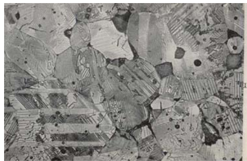
FIG. 1.19 : Microstructure en domaines dans une céramique polycristalline : cas du BaTiO 3 [27].
