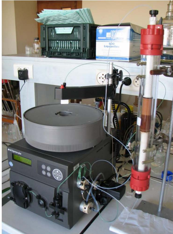
Figure B-25 : Photographie de l'appareil Äktaprime (à gauche) et d'une colonne au début du conditionnement en phase de mouillage.
