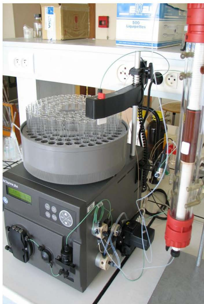
Figure B-27 : Äktaprime et colonne au cours d'un traçage avec le collecteur de fractions en fonctionnement.
