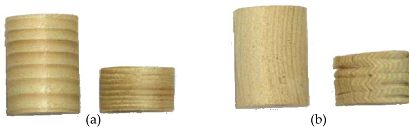
Figure 83 : Eprouvettes avant puis après compression (a) direction radiale, (b) direction tangentielle
