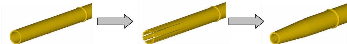
Figure 58 : Préparation de l'embout d'un chaume de bambou pour la mise en place d'un assemblage précontraint
