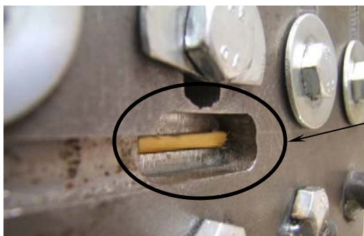
Figure 117 : Problème lié au double profilage de l'éprouvette : fluage important de la matière lors de la phase de densification
