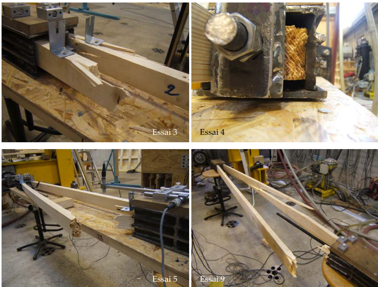
Figure 79 : Ensemble avivés – assemblages précontraints ayant subit une rupture dans un de ses avivés
