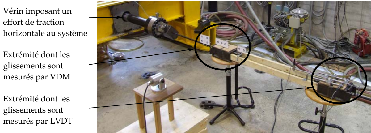
Figure 216 : Dispositif expérimental permettant de tester l'assemblage précontraint en traction longitudinale et d'en mesurer ses glissements
