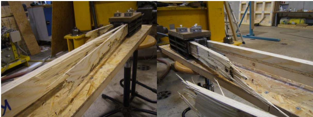
Figure 212 : Ruptures observées pour les essais d'assemblages précontraints pour les avivés en LVL
