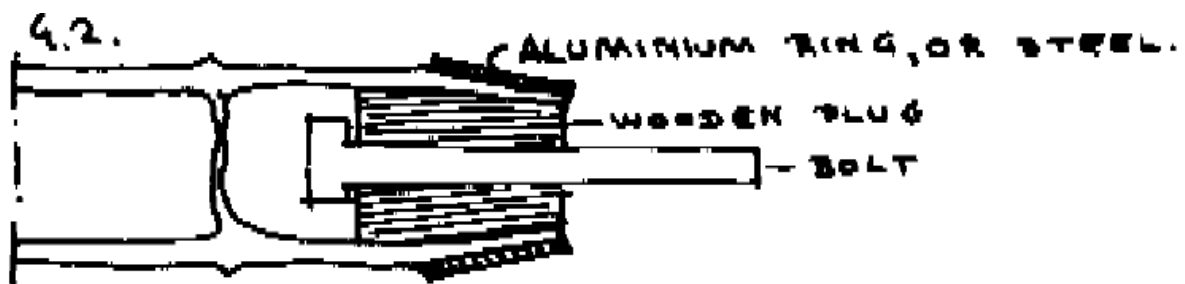
Figure 51 : Assemblage imaginé par Duff en 1941 [JAN 1981]
