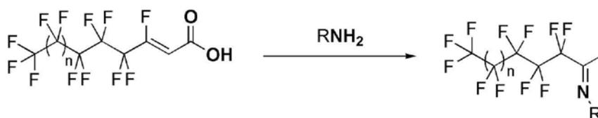
Schéma 21 : Schéma général de formation des imines
