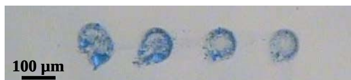
Figure 4.15 : Photographie de microscopie optique d'une série de micro-dépôts de silice obtenus sur verre en appliquant à une UME de platine (25 \mu\text{m} de diamètre), placée à 25 \mu\text{m} du substrat, un potentiel réducteur de -1,3 V pendant 60 s dans un sol n_{\text{CTAB}}/n_{\text{TEOS}} = 0,32 .
