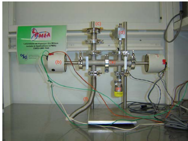
FIG. 4.7 – Banc de test sous vide des membranes SAW. (a) corps de l'enceinte (b) Jauge de pression capacitive (c) Bride de serrage / membrane encastrée (d) Electrovanne (e) Vanne micro-fuite (f) cordon de raccordement à la pompe primaire.
