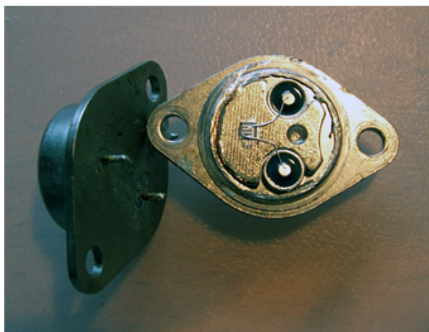
FIG. 2.18 – Exemple de packaging d'un transistor de puissance dans un boîtier métallique.
