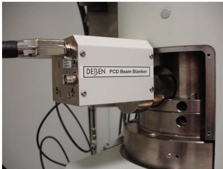
FIG. 2.5 – L’escamoteur de faisceau DEBEN installé sur la colonne du microscope électronique.
