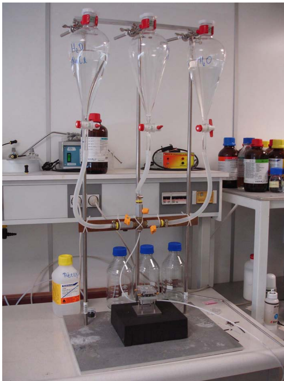
FIG. 4.33 – Banc de mesure pour le capteur de liquide Liquichip .
