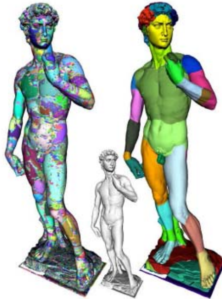
Figure 51. La décomposition exacte du David en composantes convexes (à gauche, 85 132 patches) et une décomposition approchée (à droite, tolérance de 0.04, 66 patches) [LIE06b]
