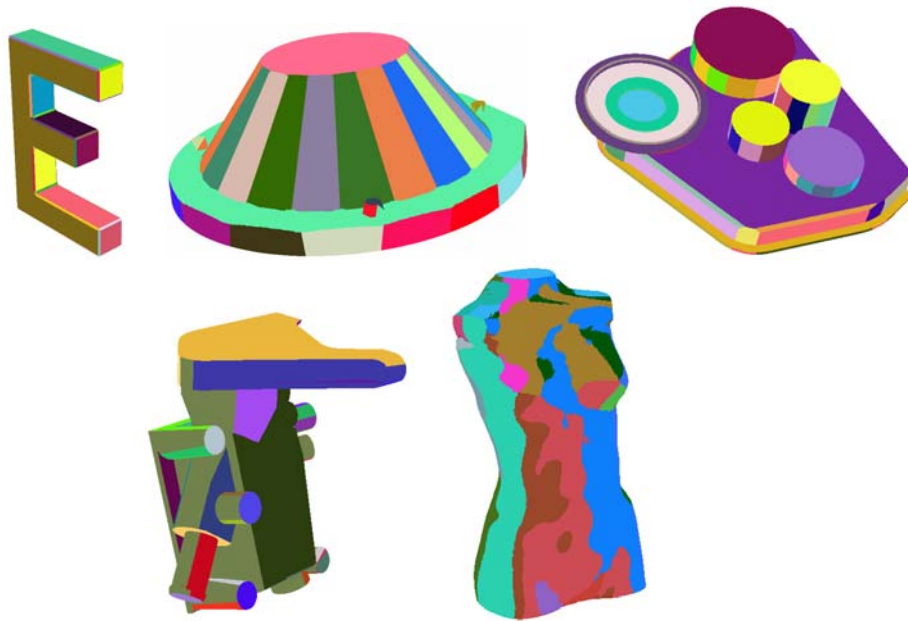
Figure 33. Exemples d'utilisation d'une décomposition surfacique du modèle par un ensemble de plans (méthode Variational Shape Approximation [COH04]). Captures résultant de notre implémentation de l'algorithme
