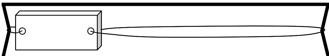
Figure 8 : Schéma du porte-échantillon (d'après [39]).
