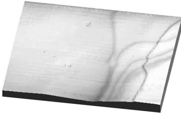
Figure 46 : Topographie de la surface de l'échantillon après clivage (champ de 180 par 150 nm avec une variation maximum de hauteur de 15 nm).
