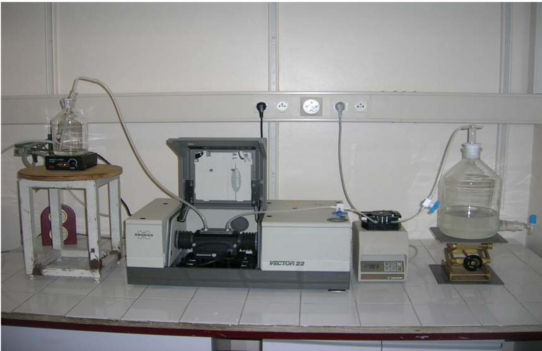
Figure II- 9 : Photographie du montage expérimental utilisé lors des expériences de formation et suivi de biofilms.
