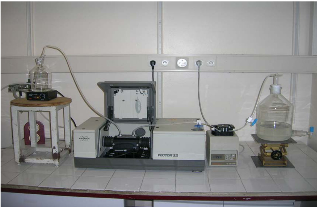
Figure II- 9 : Photographie du montage expérimental utilisé lors des expériences de formation et suivi de biofilms.
