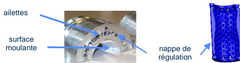
Figure 145 : Canaux conformables et nappes de régulation (Pelaingre, 2003)
