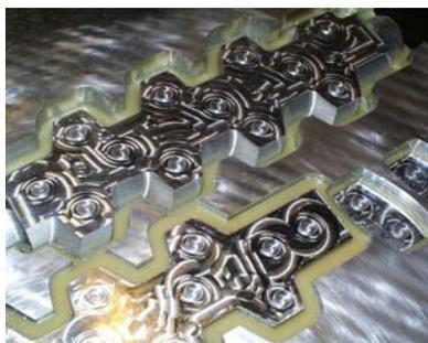
(a) Usinage des strates avec les plots et les logements
