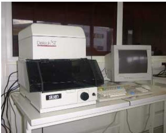
**Fig. 2.10:** Photographie du profilomètre mécanique (Dektak ST)
