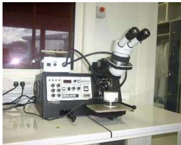
**Fig. 2.9:** Photographie de l'appareil à bonding
