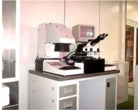
**Fig. 2.6:** Photographie de l'aligneuse-masqueuse MA 750
