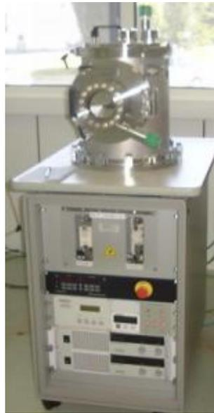
**Fig. 2.3:** Photographie du bâti d'évaporation
