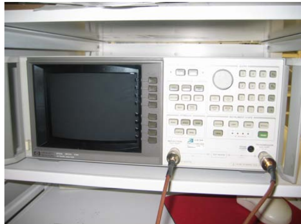
Fig. 2.16: Photographie de l'analyseur de réseau HP8752A
