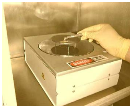
Fig. 2.5: Photographie de la plaque chauffante utilisée pour le recuit de la résine
