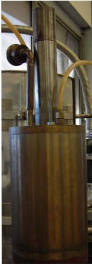
Ci-dessus : Vue de l'enceinte en laiton dans le four tubulaire
