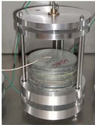
Figure 21 : Vue d'ensemble du dispositif de fluage développé pour cette étude. [CAR04]
