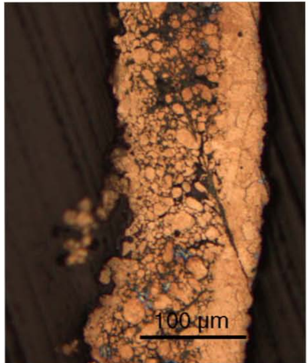
Figure 177 : Dépôt électrolytique de Pb réalisé sous 2 \text{ A.dm}^{-2} et recuit 6 h à 80^\circ\text{C}
