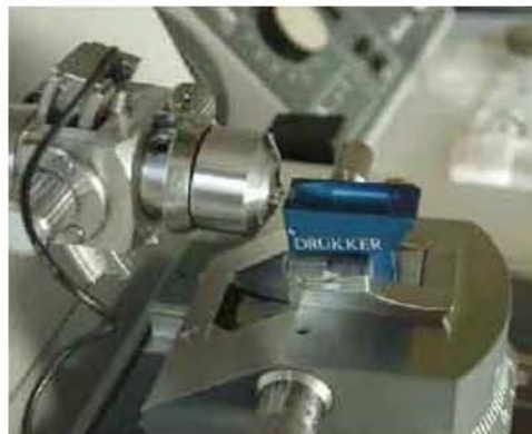
Figure 26 : Détail de la tête de découpe [BOUth03]
