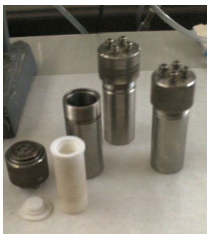
Figure 4. Autoclaves (20 mL) équipées d'un seau et d'un couvercle en téflon où l'échantillon est introduit. Ils sont placés dans une étuve à 80°C pour réaliser le traitement hydrothermal.
