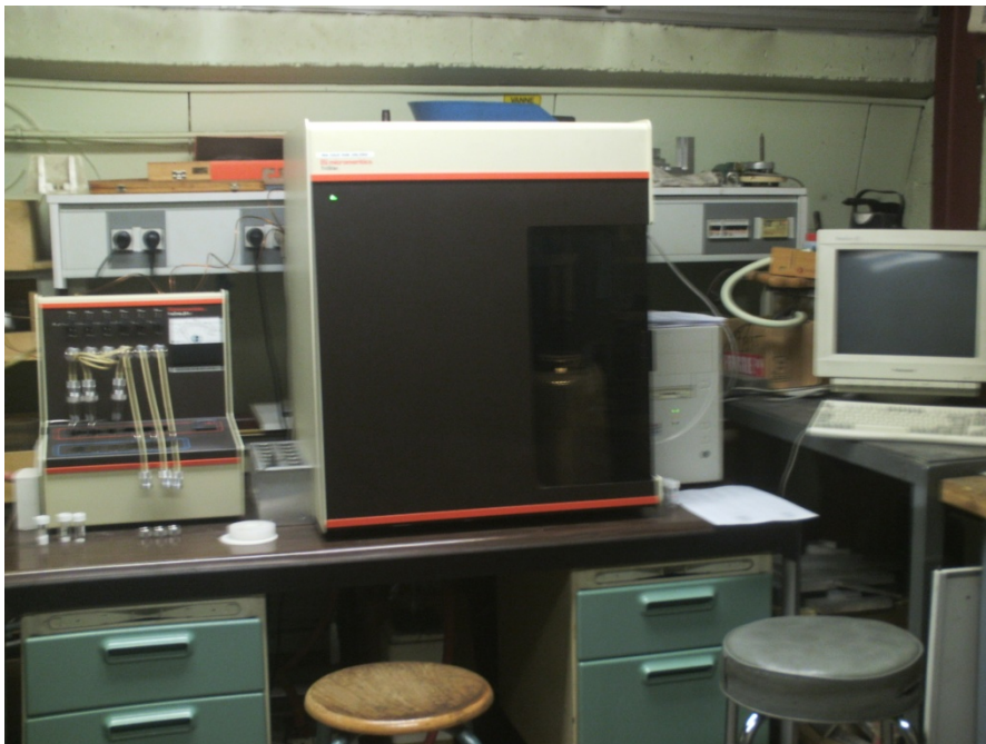
Figure 6. Montage de diffraction des rayons X aux petits angles utilisé pour déterminer la structure des phases cristal liquide et des matériaux mésoporeux.
