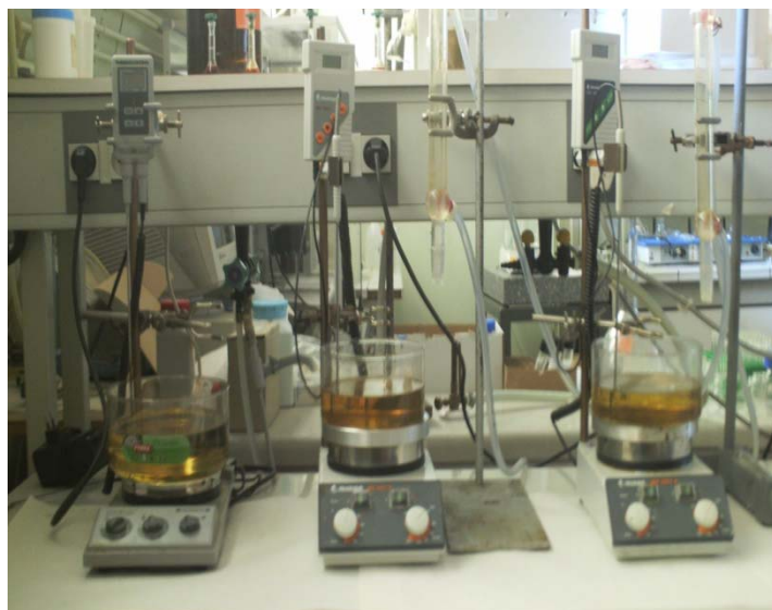
Figure 3. Bains d'huile placés sur plaques chauffantes avec agitation magnétique où l'échantillon pour la préparation des matériaux est introduit via un ballon de 25 mL.
