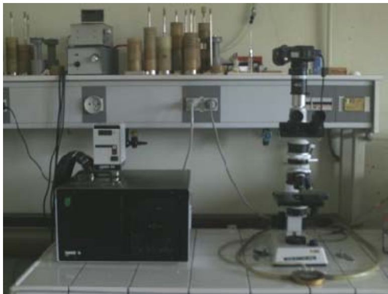
Figure 2. Microscope optique en lumière polarisée utilisé pour l'identification des phases cristal liquide. Il est relié au bain thermostaté grâce à une plaque transparente où l'échantillon est déposé couvert d'une lamelle.
