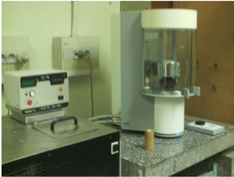
Figure 1. Tensiomètre Krüss (K 100) utilisé pour la mesure de la tension superficielle. Il est équipé d'une lame en platine et d'un cristalliseur et est relié à un bain thermostaté à circulation.
