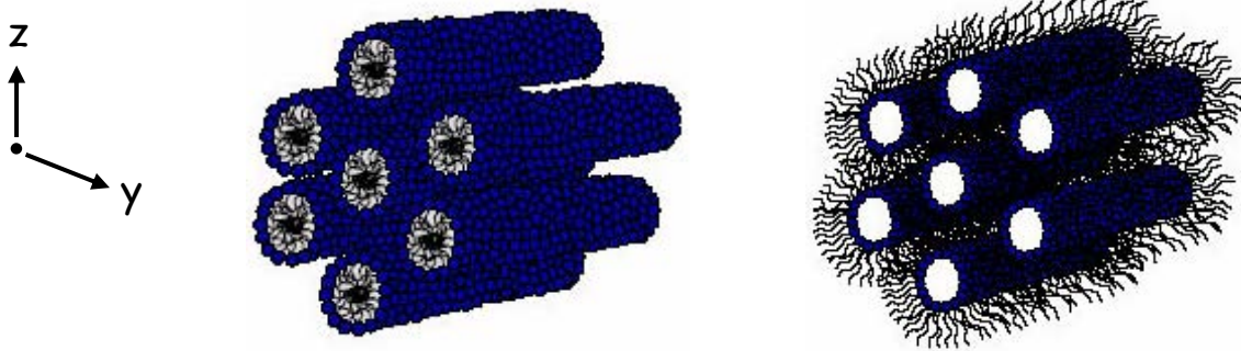
Figure 3. Représentation schématique de phases hexagonales lyotropes : a) directe H_1 et b) inverse H_2 .
