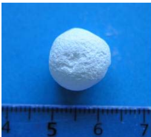
Figure 16. Photographie d'un monolithe préparé à 15% de PFOBr à pH 0,025 (échelle en centimètres)
