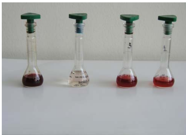
Figure 17. Changement de couleur du milieu réactionnel après addition de l'enzyme libre et immobilisée. De gauche à droite : GOD libre, solution témoin, GOD immobilisée à 30 mg/mL, GOD immobilisée à 10 mg/mL.
