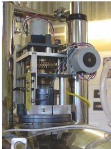
Figure 2.29 : Dispositif permettant la rotation de l'échantillon dans la sonde du spectromètre RMN. Un moteur pas à pas permet une rotation de l'échantillon d'au moins 0.18^\circ par pas. En plus de la rotation, ce dispositif permet une variation de la position verticale de l'échantillon.
