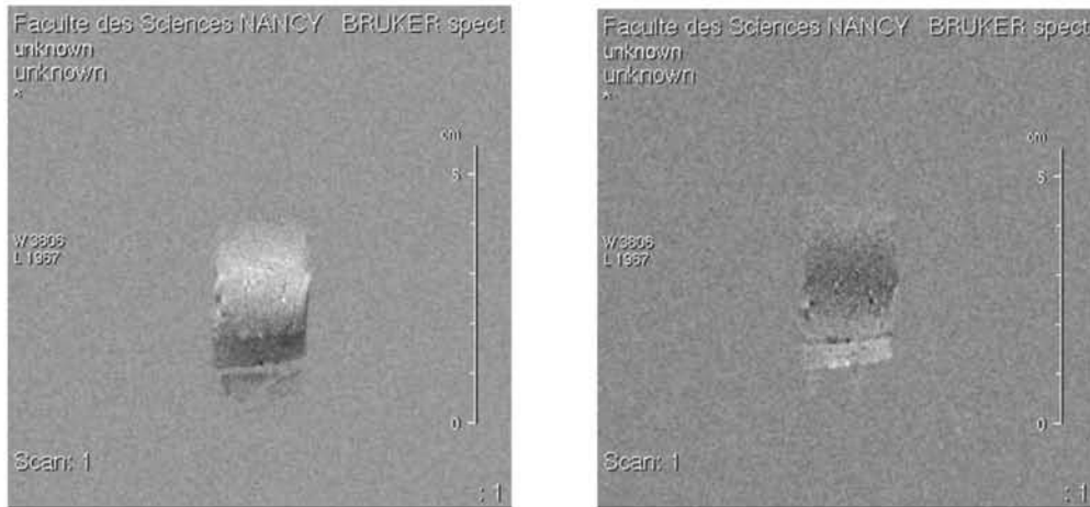
Figure 3.27 : Les zones claires indiquent une augmentation de la teneur en eau. Sur l'image de gauche (différence entre les images du centre et de gauche de la Figure 3.26), on observe une augmentation de la teneur en eau à la cathode résultant du flux électro-osmotique. A droite, le gradient de concentration entraîne la diffusion de l'eau dans la membrane (différence entre les images de droite et du centre de la Figure 3.26).
